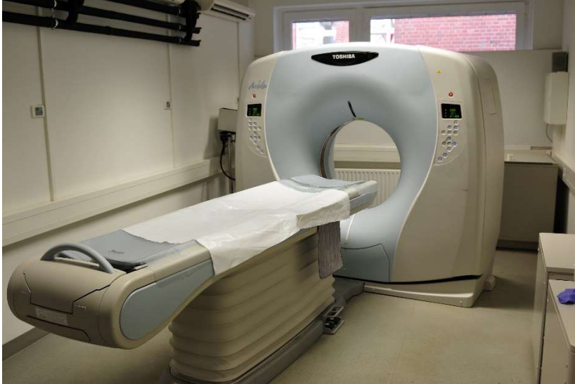
Resim 1. Bilgisayarlı tomografi cihazı. Hastanın üzerinde yattığı masa ile içinde X-ışını kaynağı ve dedektörlerin bulunduğu gantri.
