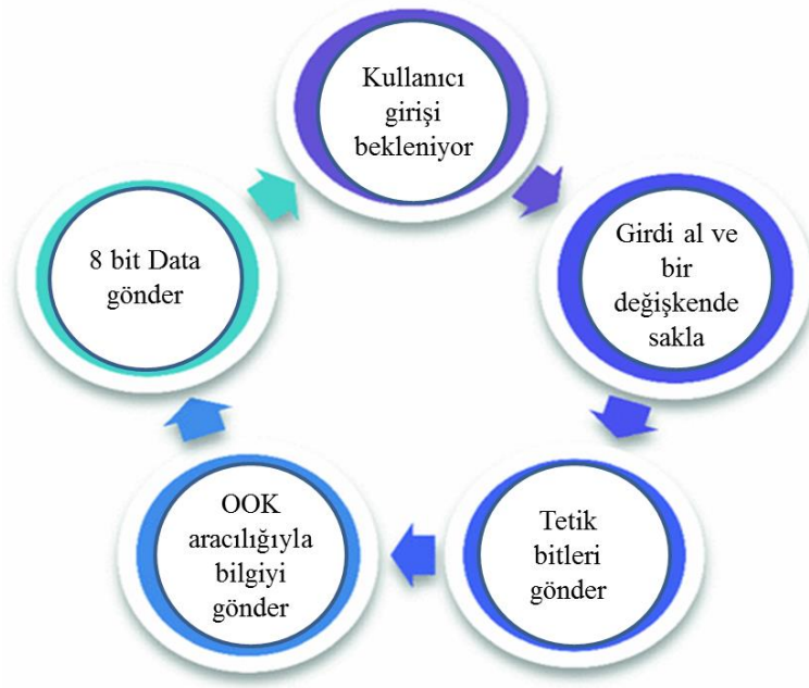
Şekil 3. 8. İletim mekanizmasının akış şeması
