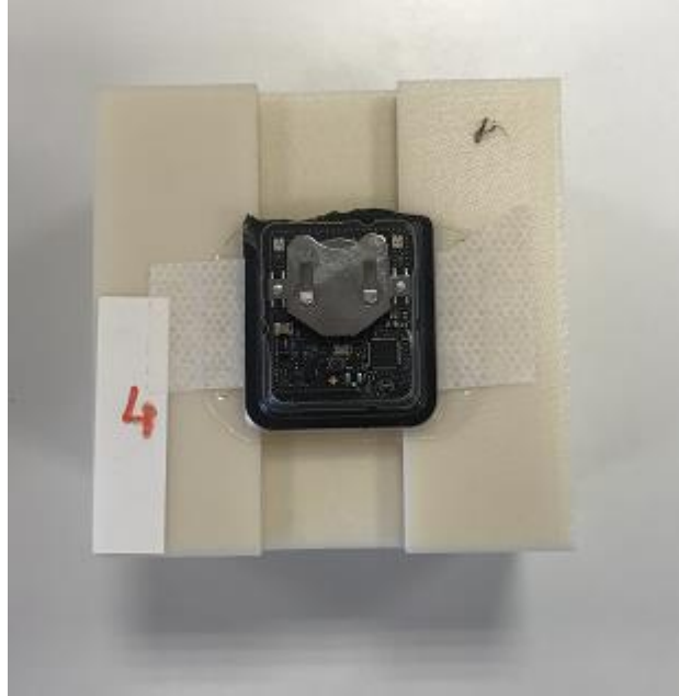
Şekil 4. 3. Verici ölçümlerinde kullanılan Bosch SCD sensör
