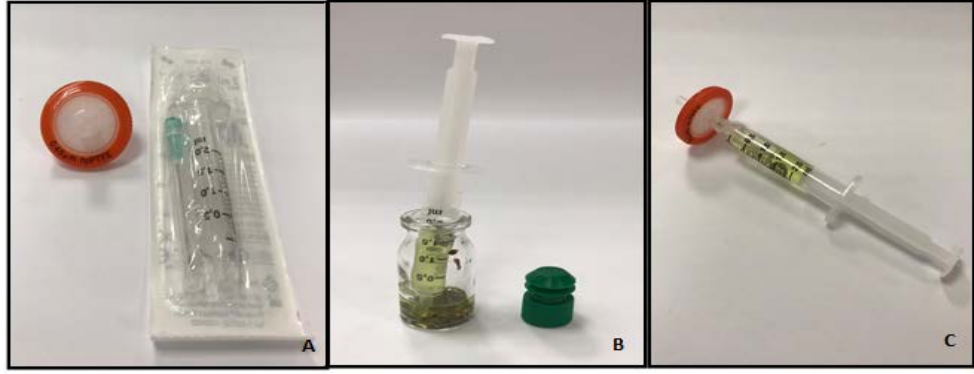
Şekil 3.3. Numunenin ayrılması A) Filtre ve enjektör B) Numunenin enjektöre çekilmesi C) Filtreden geçirilen numune
