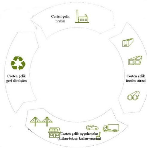
Şekil 2. 33. Corten çeliğin yaşam döngüsü (SSAB, 2022'den değiştirilip alınmıştır)
