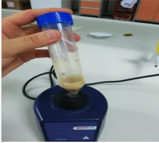
Liyofilizatın vorteks yardımıyla çözündürülmesi
