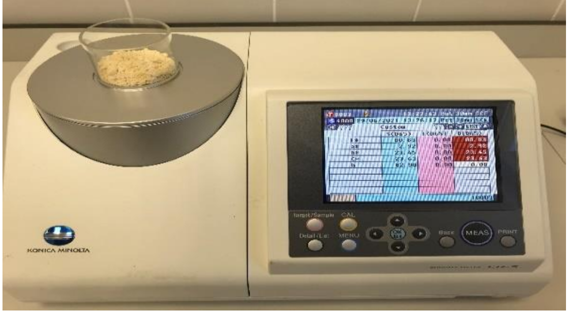
Şekil 3.2. Kraker örneklerinde renk ölçümü
