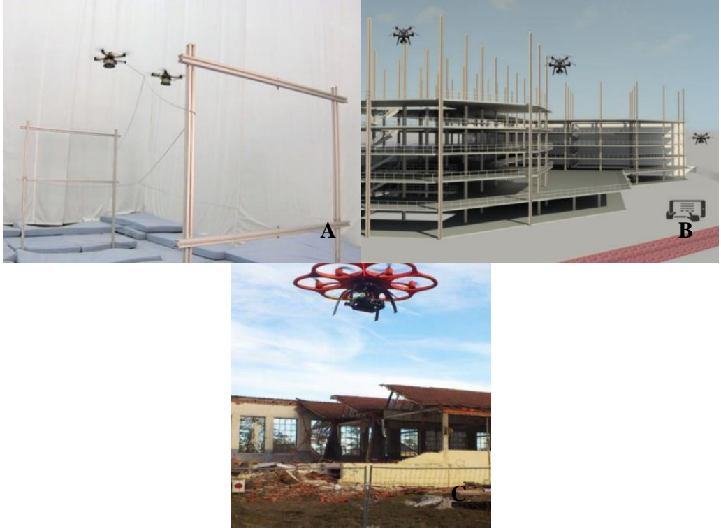
Şekil 2.13. Drone uygulamaları A) Drone kullanım öncesi deneyi B) Drone şantiye kontrolü C) Drone afet bölgesi kontrolü (Dastgheibifard ve Asnafi, 2018; Hobson, 2015)
