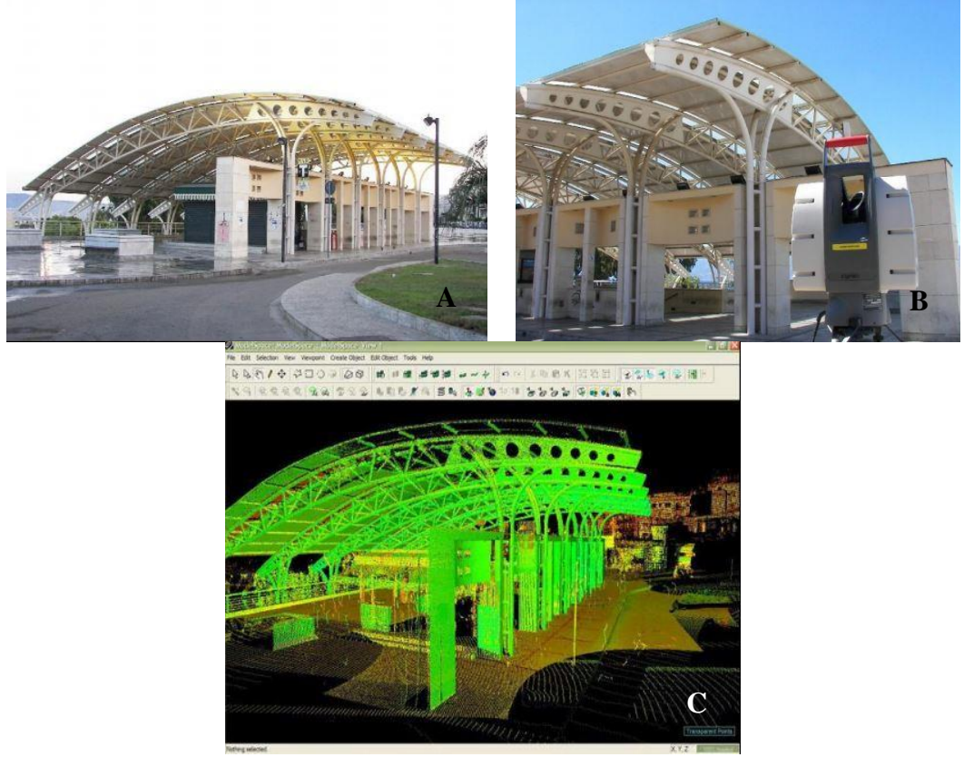
Şekil 2.16. Lazer tarayıcı ile 3 boyutlu modelin üretilmesi A,B) Lazer tarayıcıların yerleşimi C) Verilerin bilgisayar ortamına aktarımı (Barrile ve diğerleri, 2011)
