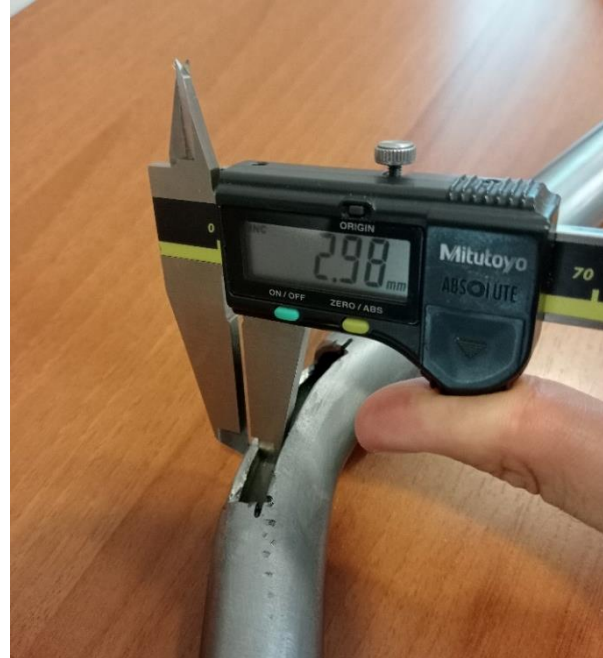
2. Büküm 45° (Et kalınlığı 2,98 mm)
