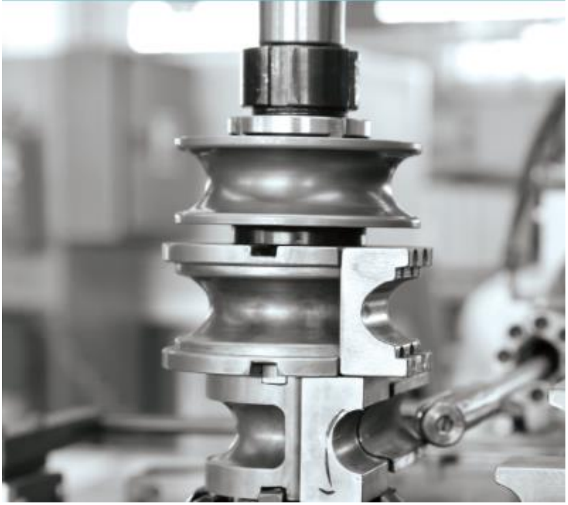
Şekil 1.2. Boru bükme makinasında büküm topları ve kalıpları (Akyapak, 2022)
