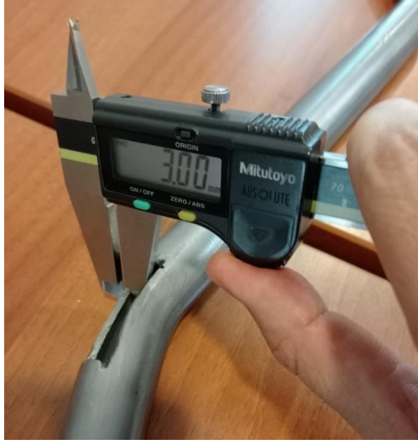
1. Büküm 30° (Et kalınlığı 3,00 mm)
