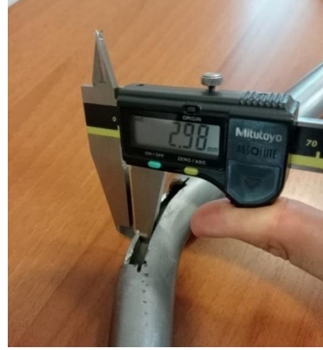
2. Büküm 45° (Et kalınlığı 2,98 mm)
