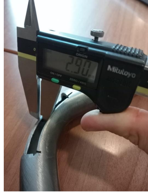
4. Büküm 75° (Et kalınlığı 2,90 mm)
