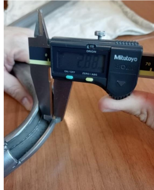
5. Büküm 90° (Et kalınlığı 2,88 mm)
