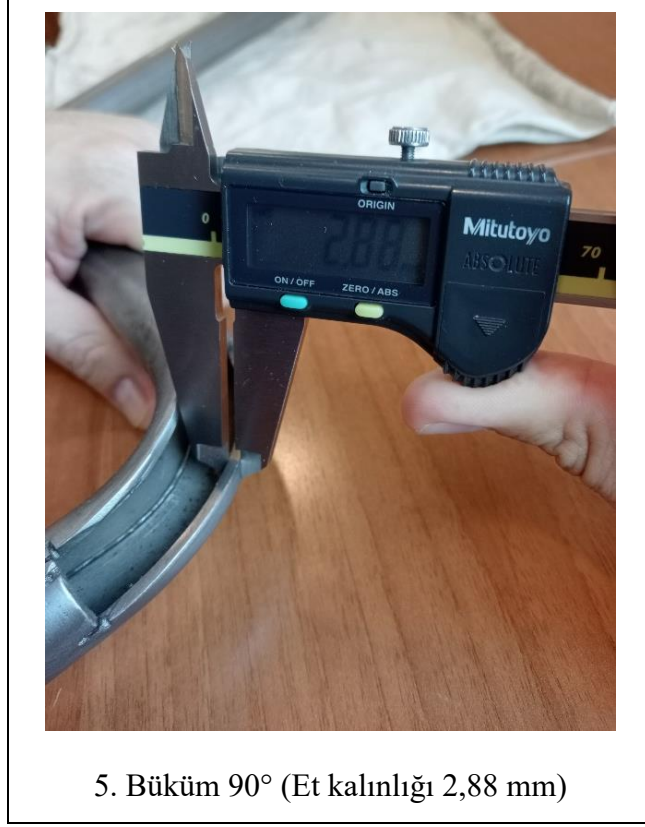
Şekil 4.14. Gerçek et kalınlığı büküm ölçüleri 30° – 45° - 60° - 75° - 90° (devam)
