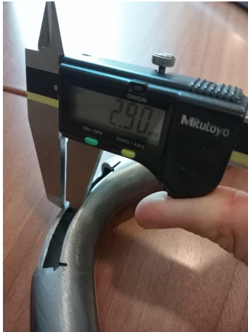
4. Büküm 75° (Et kalınlığı 2,90 mm)
