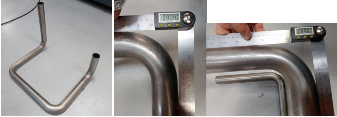
Şekil 4.6. 90 derece büküm sonuçları
