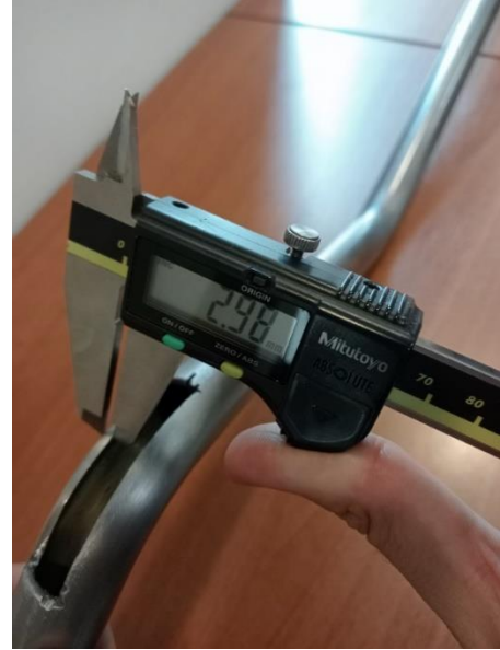
3. Büküm 60° (Et kalınlığı 2,98 mm)
