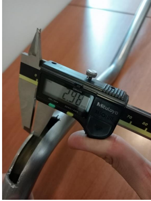
3. Büküm 60° (Et kalınlığı 2,98 mm)
