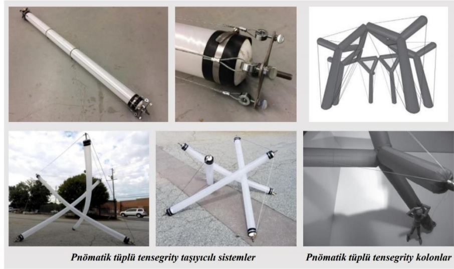
Şekil 3.26. Pnömatik tüplü tensegrity sistem örnekleri (Dessi-Olive, Case, Kolmer, Teja Meda, Putman, 2019; Martens, Tschuppik, 2006, s. 466)
