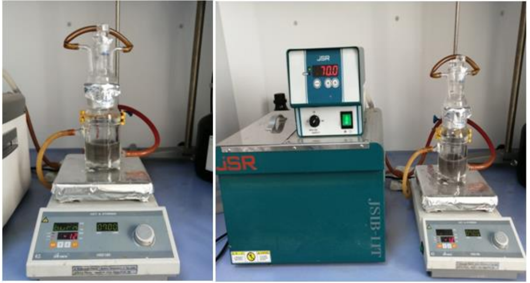
Şekil 3.1. Süspansiyon polimerizasyonu yöntemiyle partikül üretim prosesi
