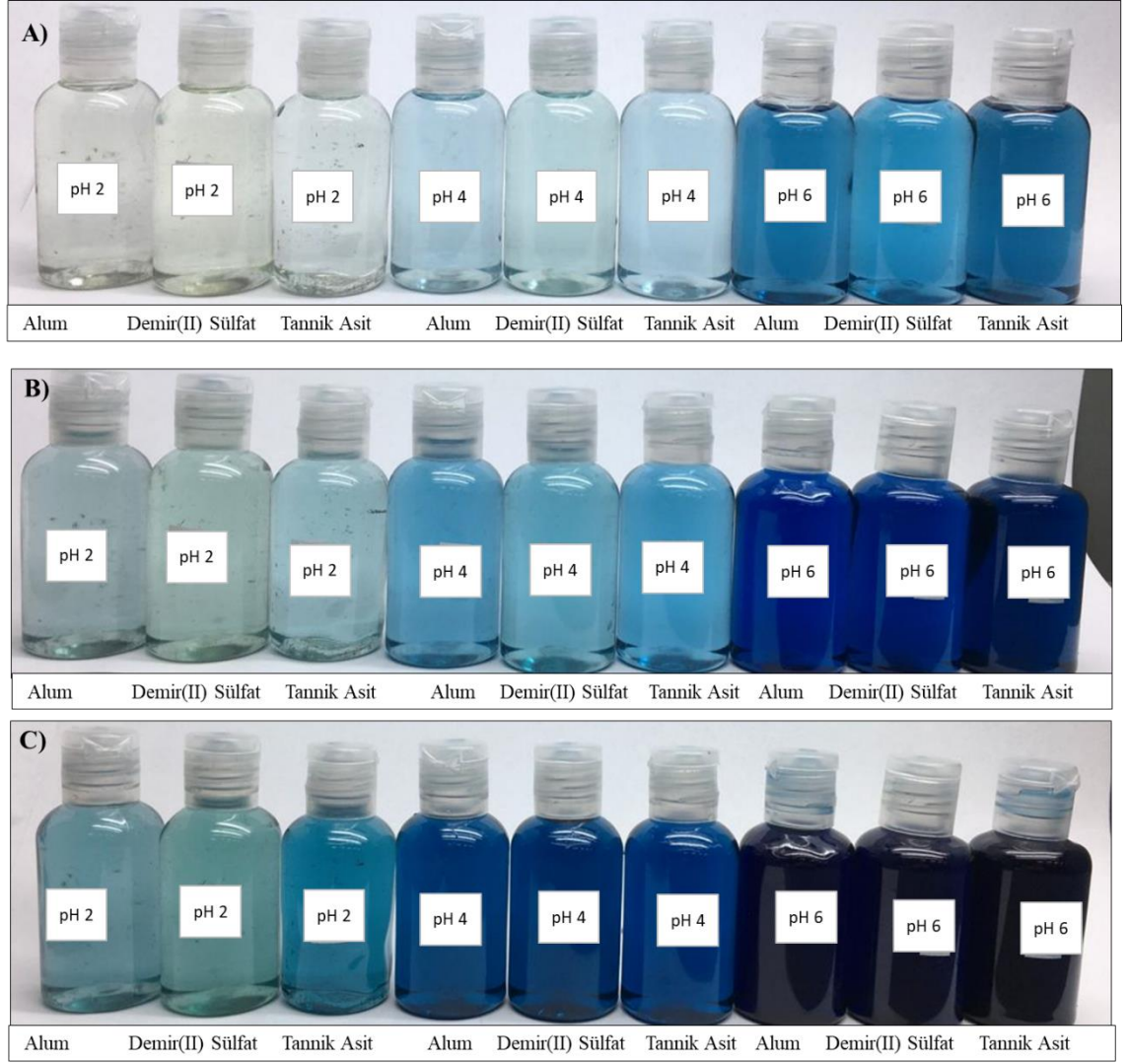
Şekil 4.11. MCT+VS kullanılarak son mordanlama yöntemi sonrası boyanan kumaşların boyama sonrası çözelti görselleri A) %0,5 MCT+VS B) %1 MCT+VS C) %2 MCT+VS
