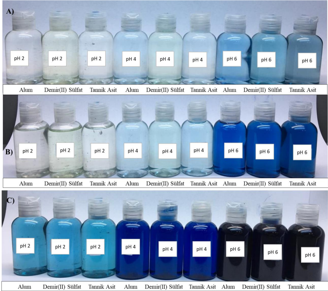
Şekil 4.6. TFP boyarmaddesi kullanılarak eş zamanlı mordanlama yöntemi sonrası boyanan kumaşların boyama sonrası çözelti görselleri A) %0,5 TFP B) %1 TFP C) %2 TFP
