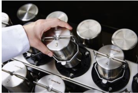
Şekil 2.23. Sıcaklık kontrollü su banyosunda dönen yıkama haslıđı test cihazı (Millington 2017)
