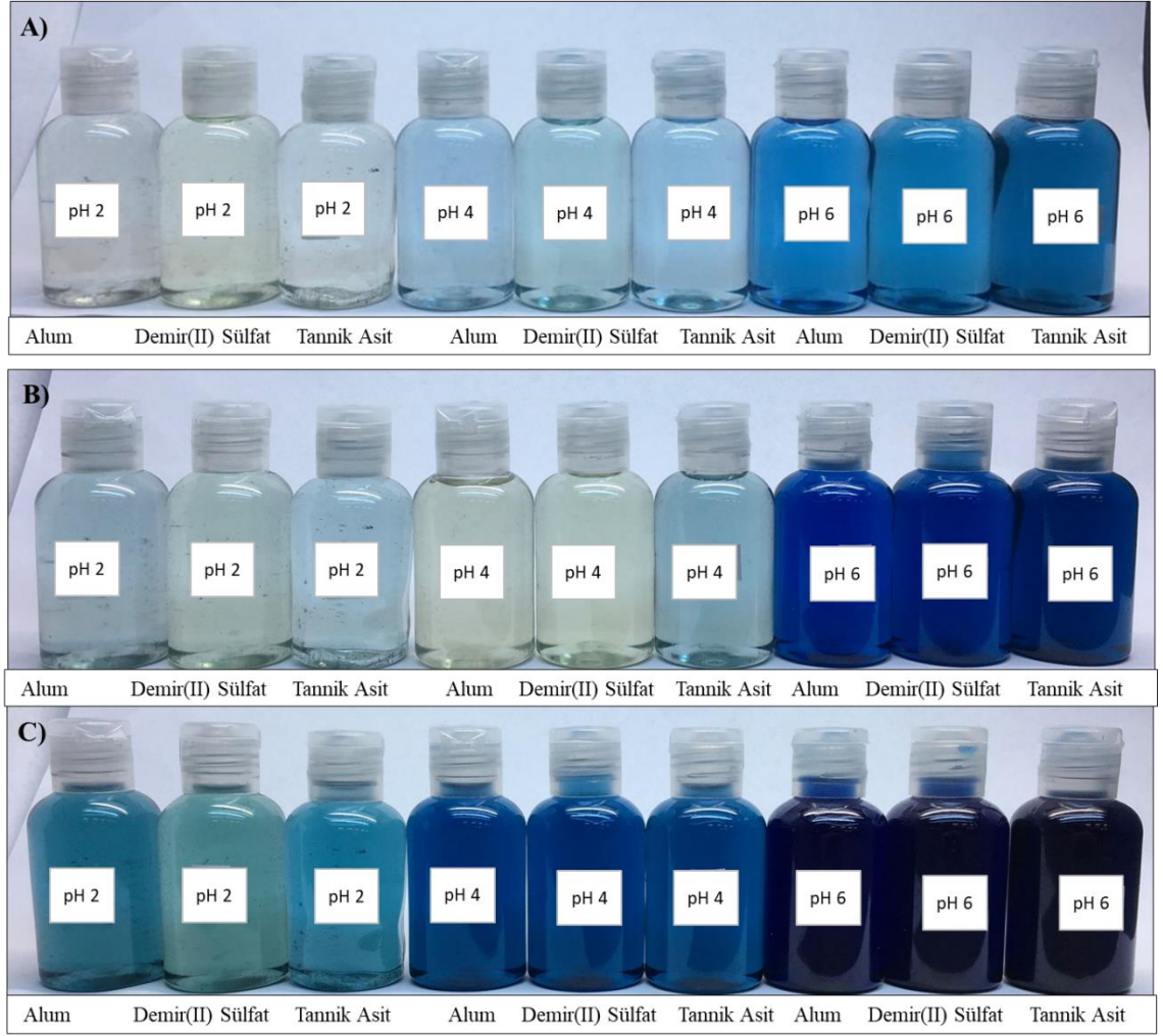
Şekil 4.10. MCT+VS ile eş zamanlı mordanlama yöntemi sonrası boyanan kumaşların boyama sonrası çözelti görselleri A) %0,5 MCT+VS B) %1 MCT+VS C) %2 MCT+VS
