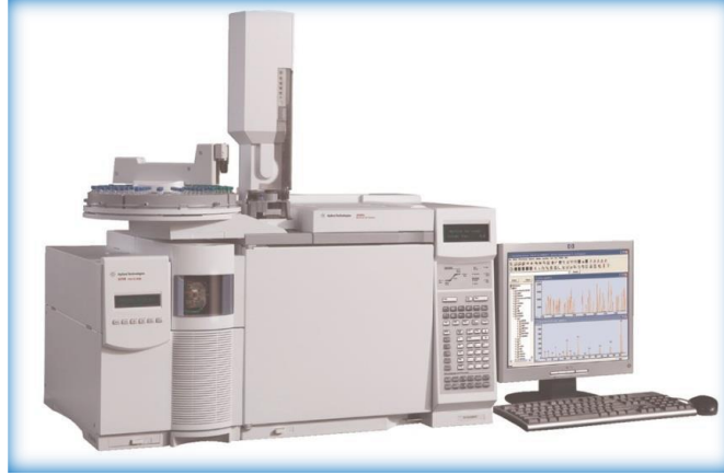
Şekil 2.13. GC-MS cihazı (Choi ve diğerleri, 2013).
