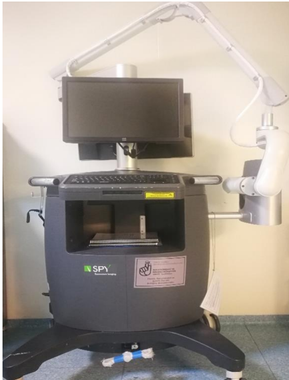
Şekil 8: SPY Elite Floresans Görüntüleme Cihazı (NOVADAQ SPY Fluorescence Imaging system SP3055, USA).
