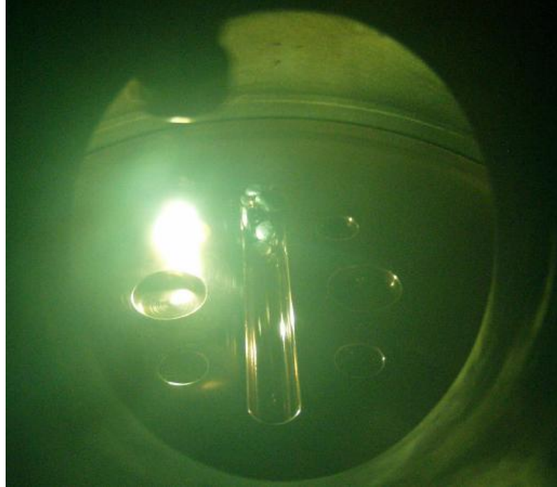
Şekil 3.2 Saf elementlerin eriyik hale geldiği vakum odası
