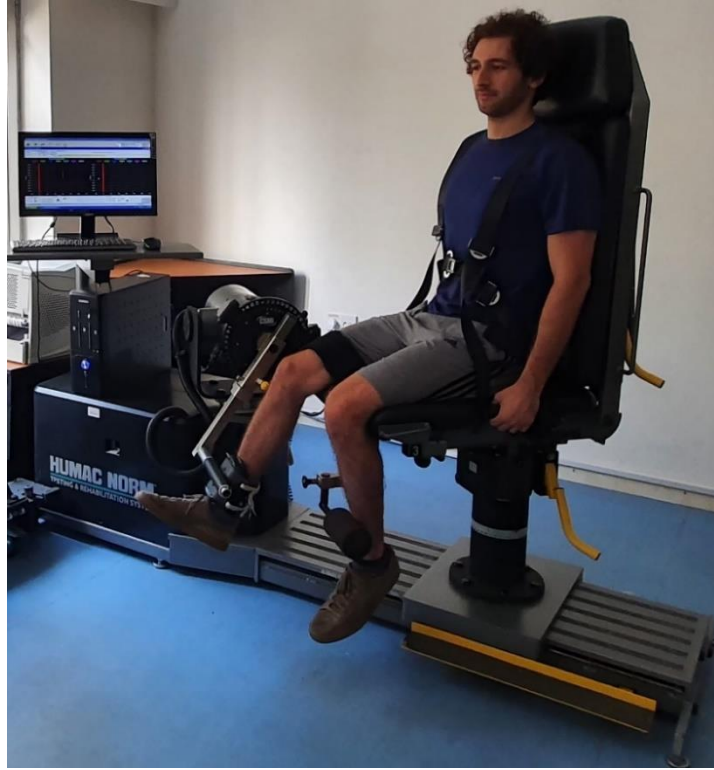
Şekil-4: İzokinetik dinamometrede kuadriseps kasının izometrik kuvvetinin ölçümü
