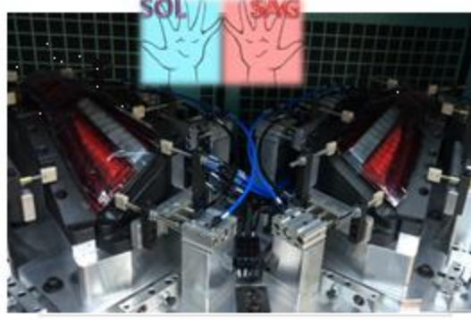
Şekil 3.9. Titreşim kaynak yönteminde lensin fikstüre yerleştirilmesi ve kaynak prosesi
