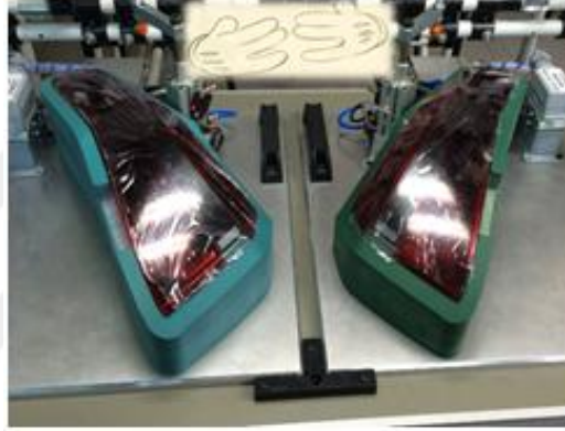
Şekil 3.7. Titreşim kaynak yönteminde lens temizleme fazı
