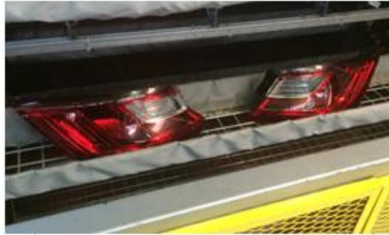
Şekil 3.38. Lazer kaynak yönteminde parçaların gerilim giderme fırınına yerleştirilmesi
