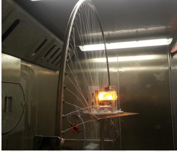
Şekil 3.47. Yoğuşma analiz test düzeneği örneği
