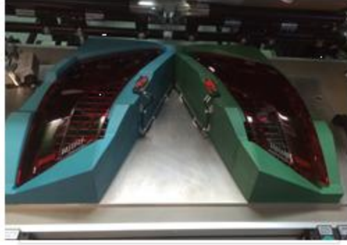
Şekil 3.34. Lazer kaynak yönteminde lens temizleme fazı
