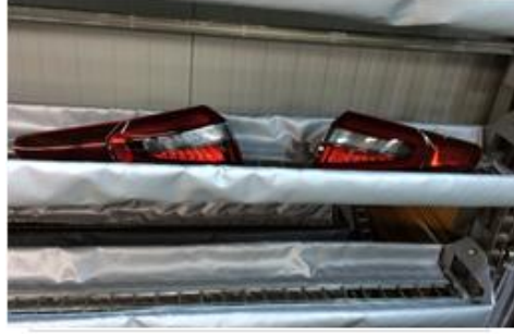
Şekil 3.11 Parçaların Gerilim Giderme Fırınına Yerleştirilmesi
