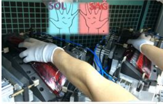
Şekil 3.10. Titreşim kaynak yönteminde görsel kontrol ve izlenebilirlik etiketini okutma
