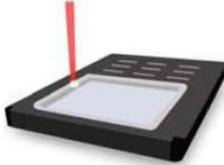
Şekil 3.21. Kontür lazer kaynak kullanım örneği (Anonim 2015)
