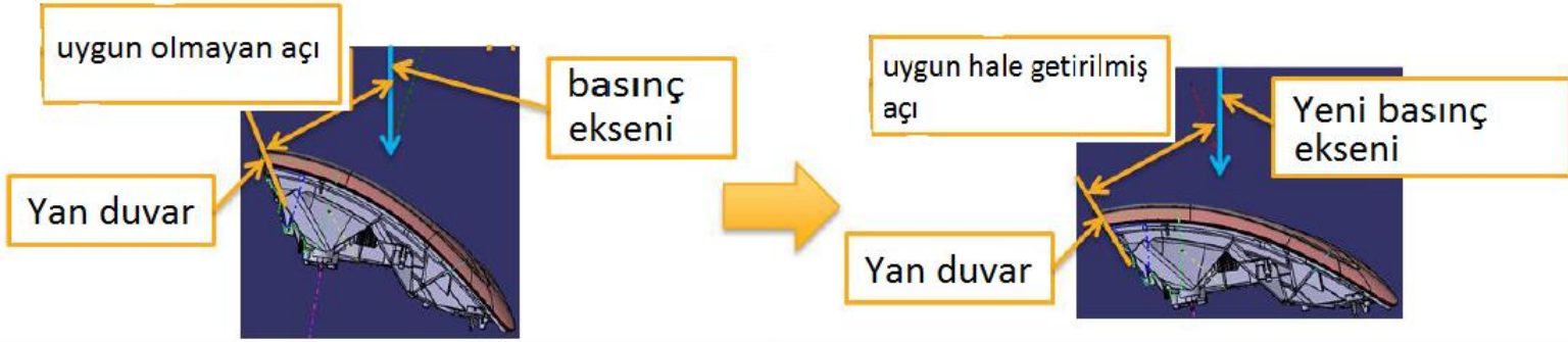
Şekil 3.31. Uygun olan (sağ) ve uygun olmayan (sol) eksen
