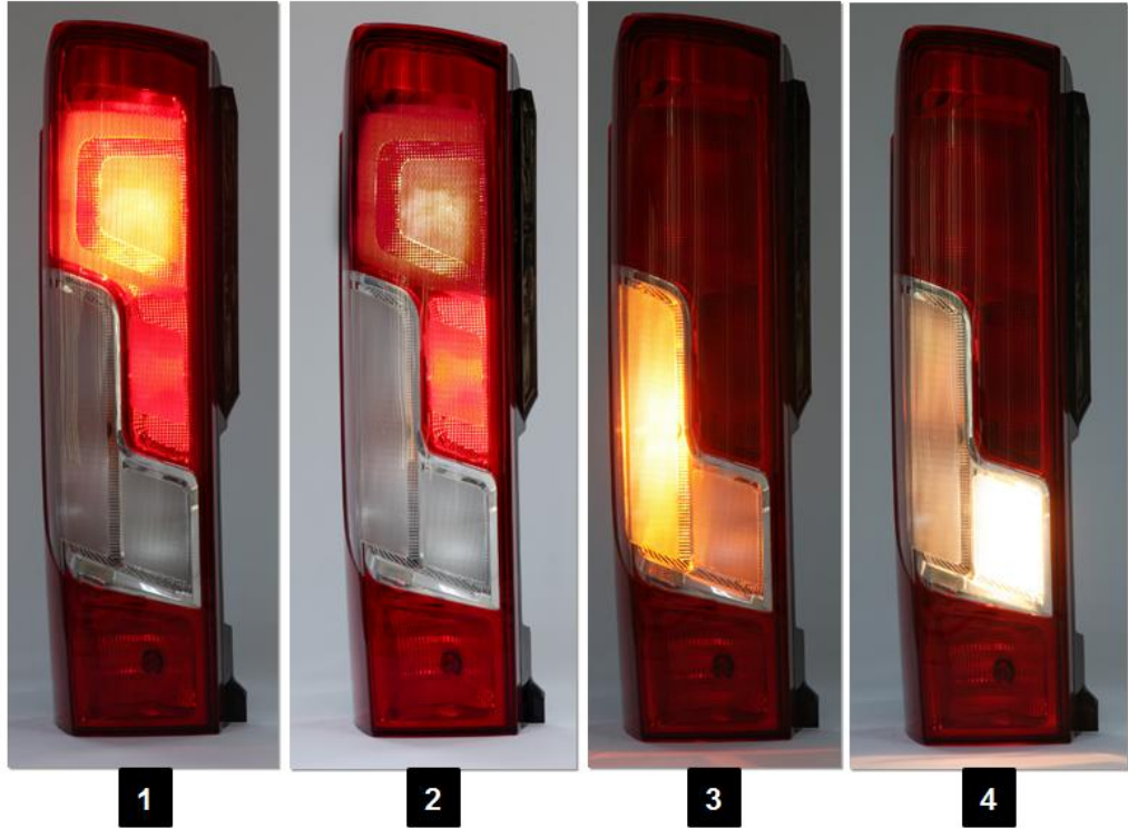
Şekil 2.9. Ducato X250 arka aydınlatma lambası 1. Fren lambası 2. Pozisyon lambası 3.Sinyal lambası 4. Geri vites lambası
