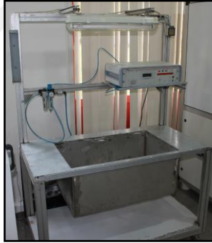
Şekil 3.51. Lazer kaynak sonrası sızdırmazlık testlerinin yapıldığı cihaz örnekleri
