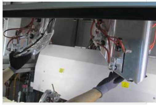
Şekil 3.16. Sıcak lama kaynak yönteminde gövdenin fikstüre yerleştirilmesi
