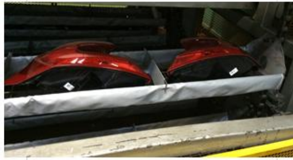
Şekil 3.19. Sıcak lama kaynak yönteminde parçaların gerilim giderme fırınına yerleştirilmesi
