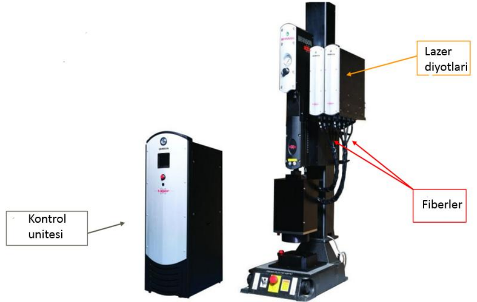
Şekil 3.28. Lazer kaynak cihazının uniteleri ( Branson Radiance 3g )
