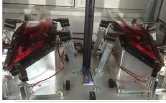
Şekil 3.36. Lazer kaynak yönteminde lensin fikstüre yerleştirilmesi ve kaynak prosesi
