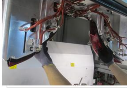
Şekil 3.18. Sıcak lama kaynak yönteminde kaynak prosesi sonrası ürünlerin fikstürden alınması
