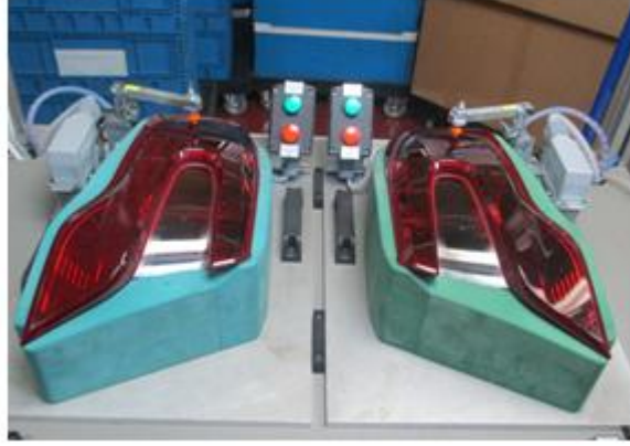
Şekil 3.15. Sıcak lama kaynak yönteminde lens temizleme fazı
