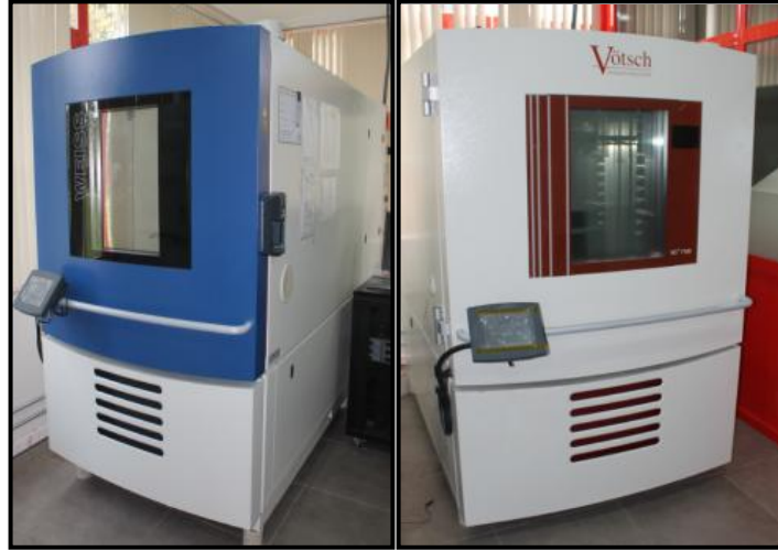
Şekil 3.50. Lazer kaynak sonrası iklimik testleri yapıldığı cihaz örnekleri
