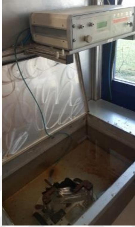
Şekil 3.48. Sızdırmazlık test düzeneği örneği
