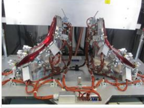
Şekil 3.17. Sıcak lama kaynak yönteminde lensin fikstüre yerleştirilmesi ve kaynak prosesi
