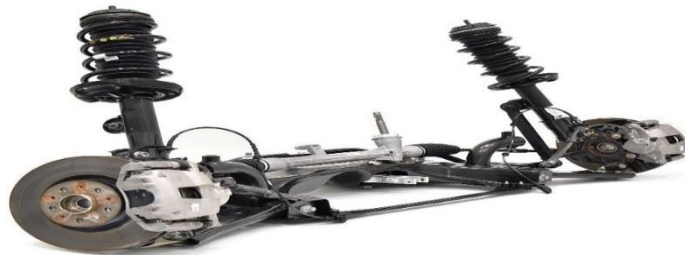
Şekil 6. Fiat Tipo 1.6 Multijet modelinin süspansiyon sistemi (A2MAC1, 2019)
