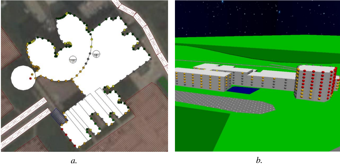
Şekil 5: CadnaA Modeli İki Boyutlu ve Üç Boyutlu Alıcı Noktaları; a. Üniversite Hastanesi b. Mühendislik Fakültesi
