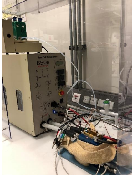
Şekil 2: Yakıt pili performanslarının gerçekleştirildiği test cihazı
