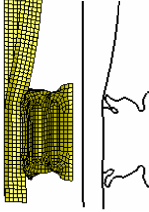
Şekil 5.126. %100 offset n=3, t=5 mm için darbe emici katlanma formu
