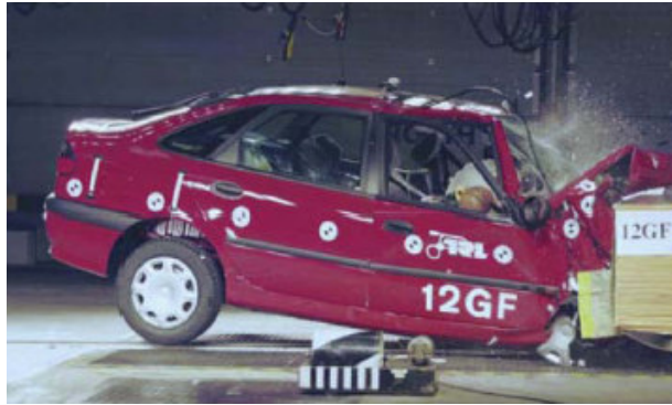
Şekil 4.2. Önden çarpma testi
