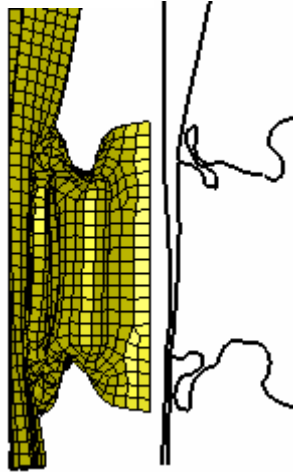
Şekil 5.117. %100 offset n=3, t=2 mm için darbe emici katlanma formu
