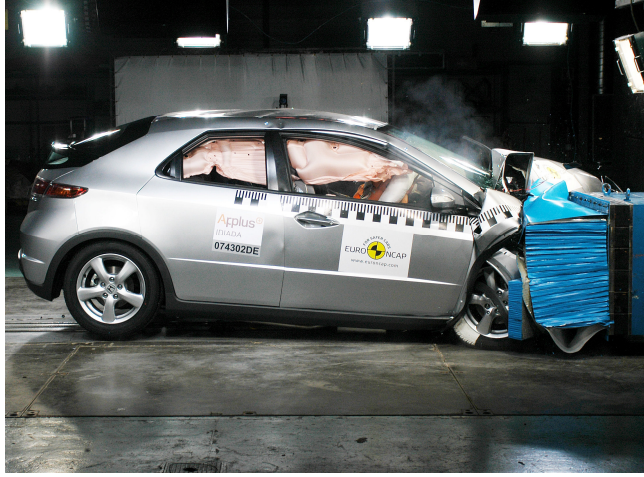
Şekil 4.1. Bir Euro NCAP araç çarpışma testi
