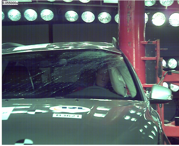
Şekil 4.4. Yandan çarpma kafa koruma testi
