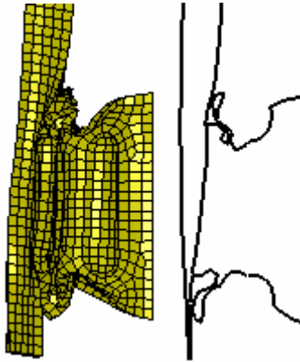
Şekil 5.54. %40 offset n=3, t=1 mm için darbe emici katlanma formu
