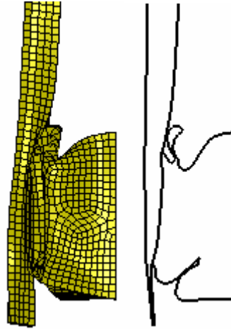
Şekil 5.24. %40 offset n=1, t=1 mm için darbe emici katlanma formu
