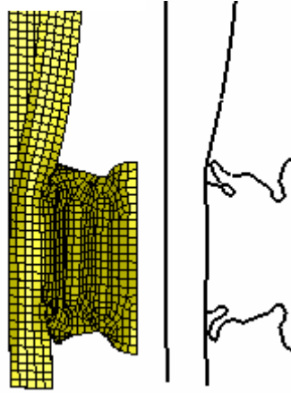
Şekil 5.66. %40 offset n=3, t=5 mm için darbe emici katlanma formu
