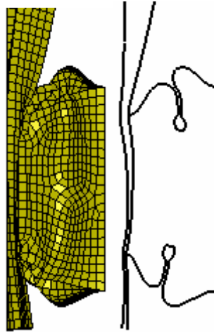
Şekil 5.87. %100 offset n=1, t=2 mm için darbe emici katlanma formu
