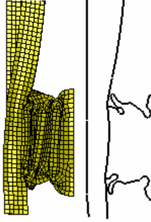
Şekil 5.63. %40 offset n=3, t=4 mm için darbe emici katlanma formu
