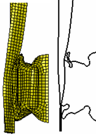
Şekil 5.57. %40 offset n=3, t=2 mm için darbe emici katlanma formu
