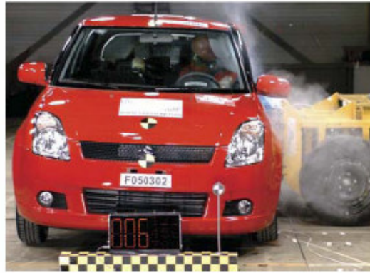
Şekil 4.3. Yandan çarpma testi
