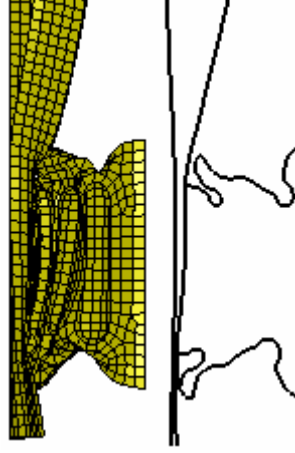
Şekil 5.120. %100 offset n=3, t=3 mm için darbe emici katlanma formu
