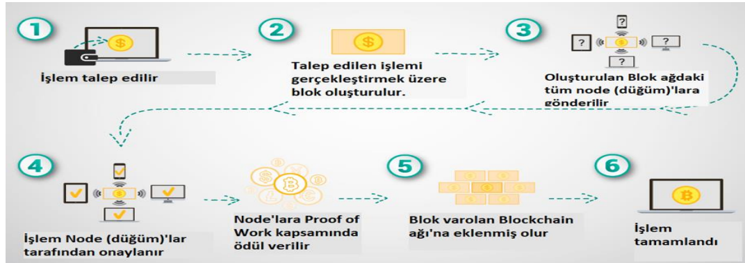
Şekil 2: Blok Zinciri Teknolojisinin çalışma mekanizması
