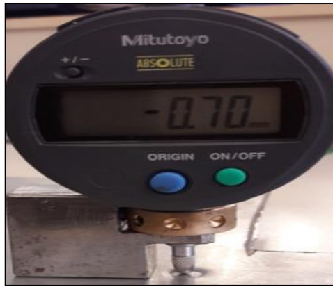
Şekil 3.11. Sacın arka yüzeyinde oluşan çökme miktarının kompratör ile ölçümü
