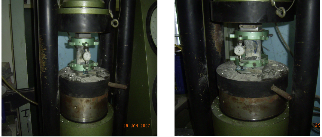
Şekil 3.45,46 Taş numunelerin elastisite modülü deneyi
