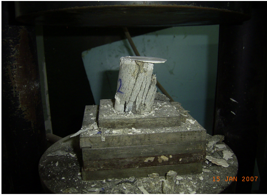
Şekil 3.43 Silindirik deretaşının basınç mukavemeti deneyi
