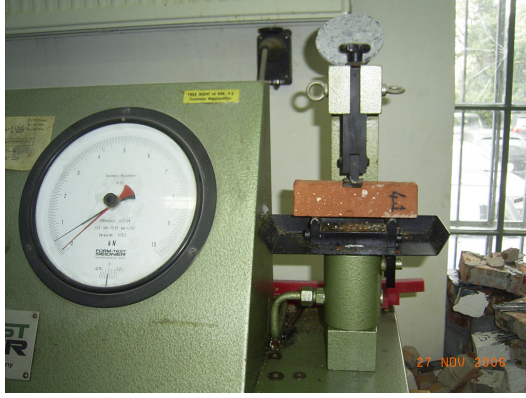
Şekil 3.39 Tuğla numunesinin eğilme deneyi sırasındaki hali
