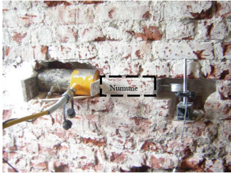
Şekil 2.11 Shearjack aletiyle kayma deformasyon ölçümleri (Aköz 2005)
