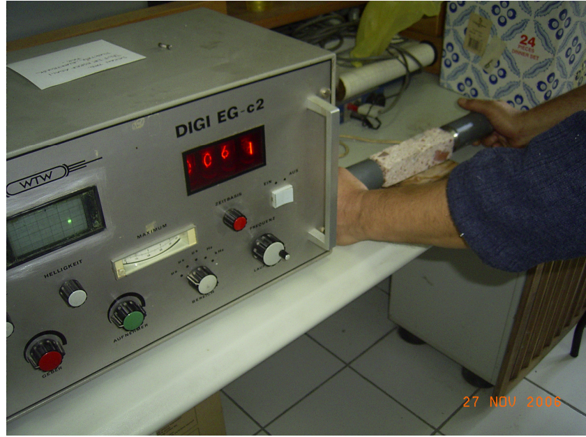
Şekil 3.38 Harç malzemesinin ultrasases geçiş süresinin tayini
