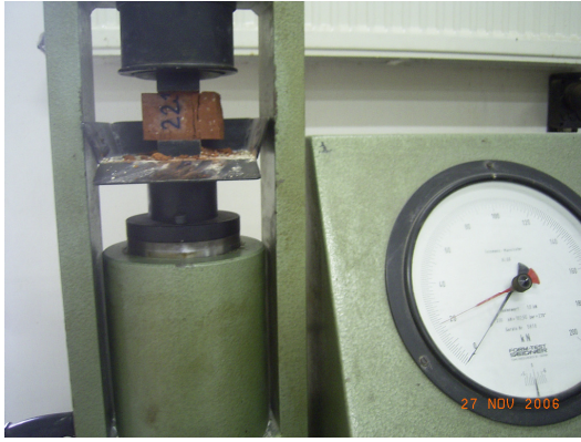
Şekil 3.41 Tuğla numunesinin küp basınç mukavemetinin belirlenmesi
