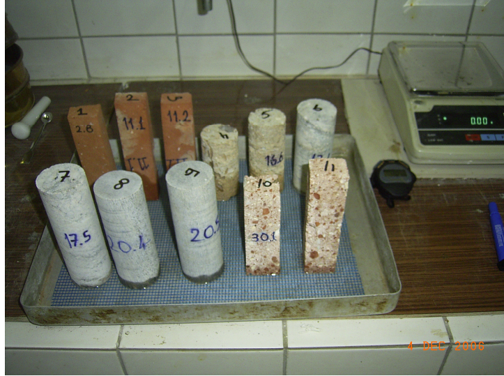
Şekil 3.31 Kılcallık deneyinin yapılması
