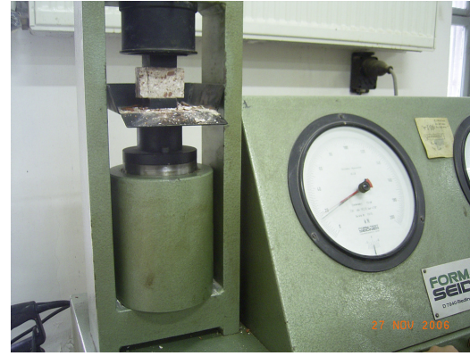
Şekil 3.42 Harç numunesinin küp basınç mukavemetinin belirlenmesi
