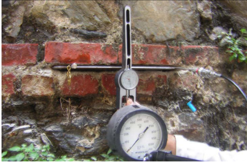
Şekil 2.10 Flatjack aletiyle deformasyon ölçümleri (Aköz, 2005)
