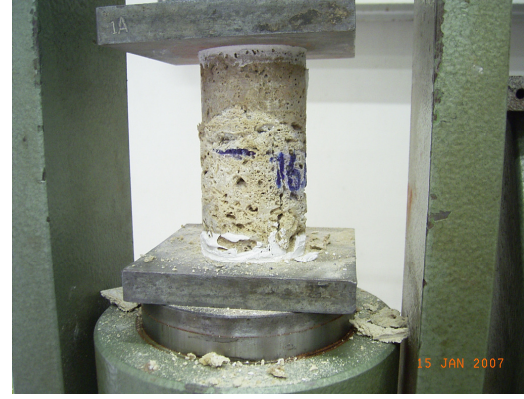
Şekil 3.44 Silindirik küfeki taşının basınç mukavemeti deneyi
