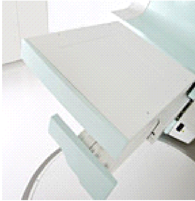
Şekil-25: OPTIVUE 1000ART EPID (Elektronik Portal Görüntüleme Cihazı).
