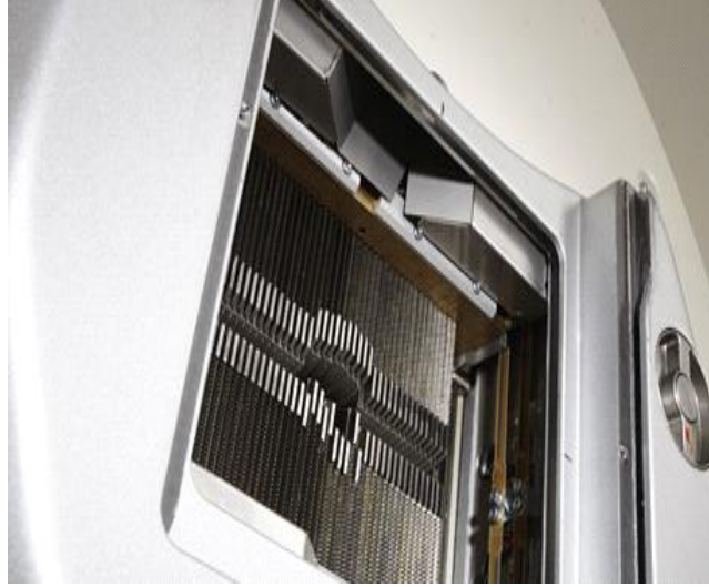
Şekil-5: Siemens 160 lif ÇYK yapısı. ( www.siemens.com/healthcare )
