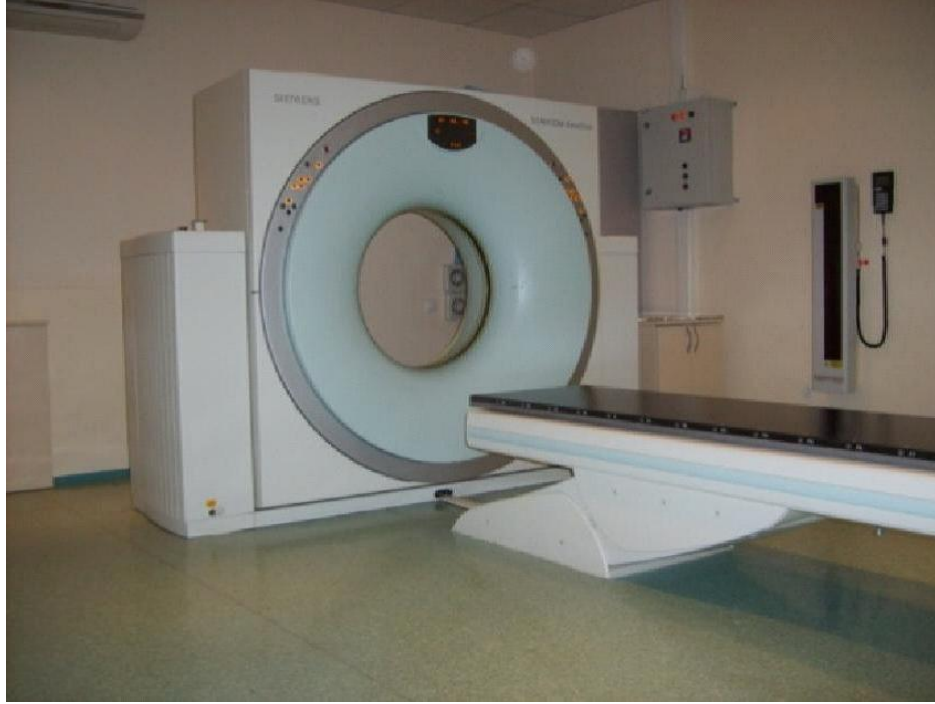
Şekil 19: SIEMENS Somatom Emotion Duo marka Bilgisayarlı Tomografi Simülatör (BTS) Ünitesi.
