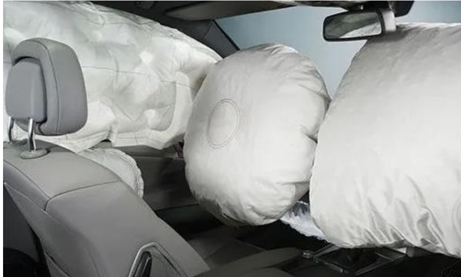
Şekil 2.5. Taşıt Teknik Tekstillerine örnek hava yastıkları (Anonim, 2020d).
