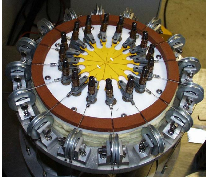
Şekil 3.7. İki eksenli eş çekme testi (Miller, 2000)
