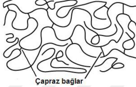
Şekil 2.15. Termoset Bağ Yapısı (Aran 2008)
