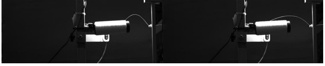
Şekil 4.97. Ne 20/1 pamuk ipliği silindirik bobin için 120 mm bobin ön yüzeyi ile iplik kılavuzu mesafesinde 800 m/dak sağım hızında oluşan balon şekline ait görüntü kayıtları
