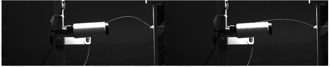
Şekil 4.98. Ne 20/1 pamuk ipliği silindirik bobin için 240 mm bobin ön yüzeyi ile iplik kılavuzu mesafesinde 800 m/dak sağım hızında oluşan balon şekline ait görüntü kayıtları
