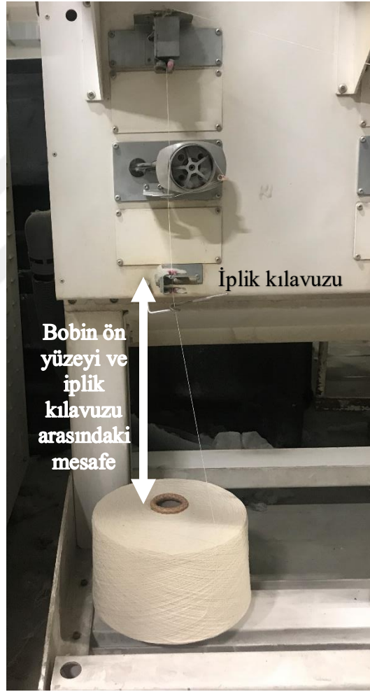
Şekil 2.15. Bobin makinesinde bobinden iplik sağım işlemi
