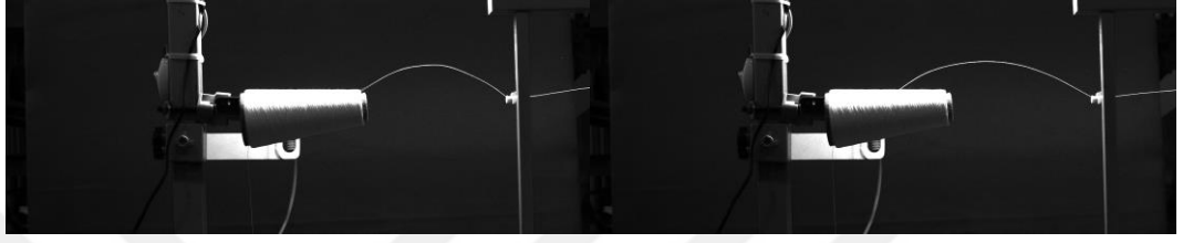
Şekil 4.101. Ne 20/1 pamuk ipliği konik bobin için 240 mm bobin ön yüzeyi ile iplik kılavuzu mesafesinde 800 m/dak sağım hızında oluşan balon şekline ait görüntü kayıtları
