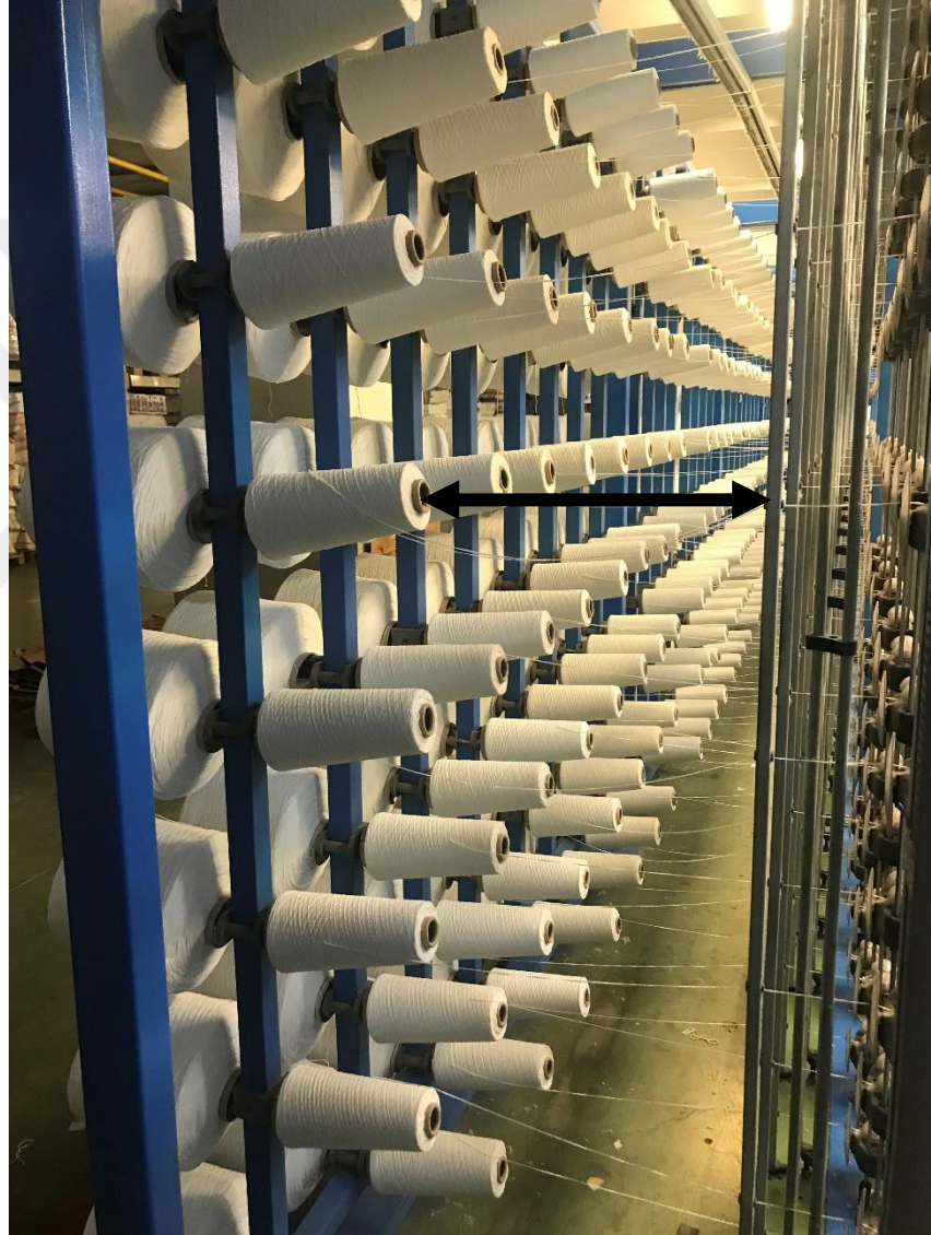
Şekil 2.16. Çözgü hazırlamada bobinden iplik sağım işlemi
