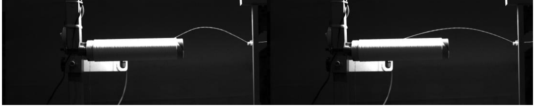
Şekil 4.95. 300 denye poliester iplik için 240 mm bobin ön yüzeyi ile iplik kılavuzu mesafesinde 800 m/dak sağım hızında oluşan balon şekline ait görüntü kayıtları
