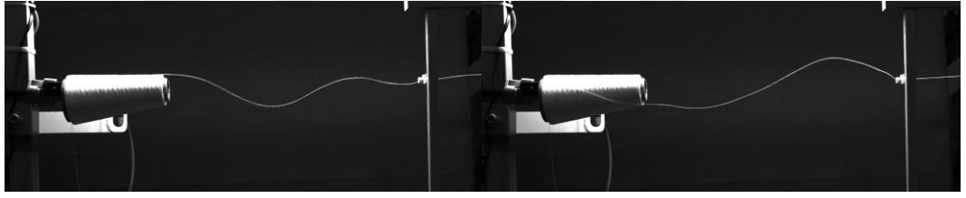
Şekil 4.102. Ne 20/1 pamuk ipliği konik bobin için 240 mm bobin ön yüzeyi ile iplik kılavuzu mesafesinde 800 m/dak sağım hızında oluşan balon şekline ait görüntü kayıtları
