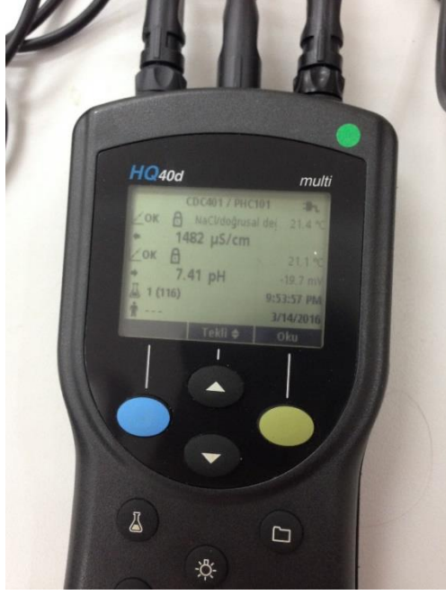
Şekil 3.5. Akçalar Mah. alınan suyun iletkenliğinin ve pH'ının ölçüldüğü cihaz
