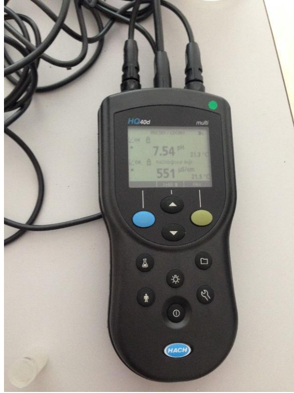
Şekil 3.7. Uludağ Üniversitesinden alınan suyun iletkenliğinin ve pH'ının ölçüldüğü cihaz
