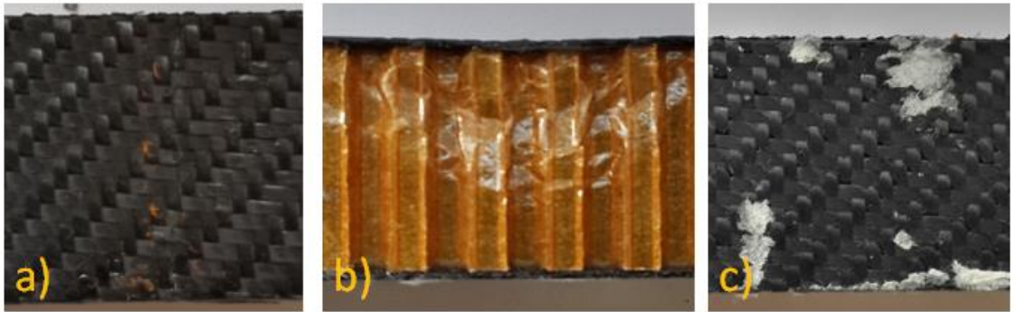
Şekil 4.56. -40°C’de 20 mm kalınlıkta Nomex çekirdekli numunenin yük uygulama bölgesi görüntüleri; a) basma yüzeyi b) yan yüzey c) gerilim yüzeyi
