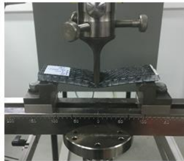
Şekil 3.21. Farklı cins çekirdek ve kalınlıklardaki test numunelerinin 3 nokta eğilme testi
