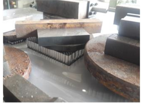
Şekil 3.15. Birleştirilensandviç numunelerinin ağırlık altında oda sıcaklığında kürlenme aşaması
