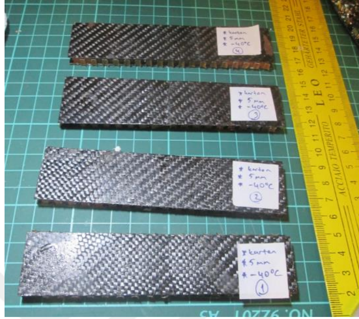
Şekil 4.20. -40°C’de 5 mm kalınlıkta Nomex çekirdekli sandviç numunelerinin üç nokta eğilme testi sonrası görünümleri
