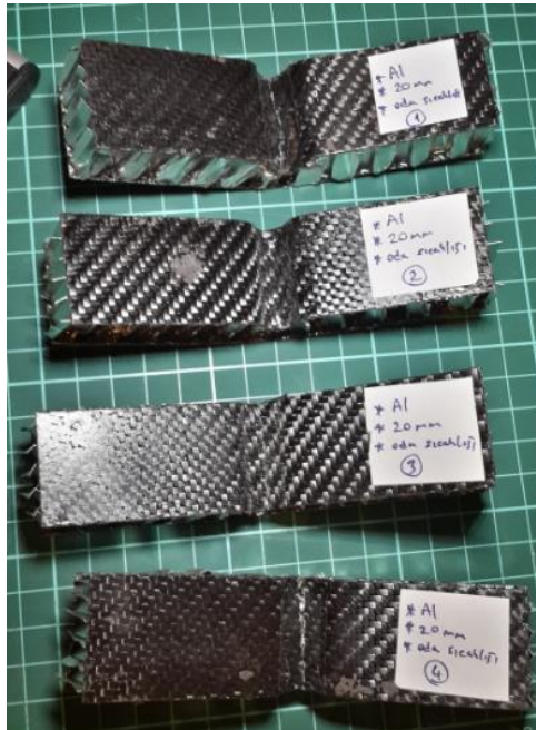
Şekil 4.17. Oda sıcaklığında 20 mm kalınlıkta Al çekirdekli sandviç numunelerinin üç nokta eğilme testi sonrası görünüşleri
