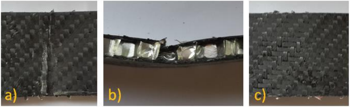
Şekil 4.61. Oda sıcaklığında 5 mm kalınlıkta Al çekirdekli numunenin yük uygulama bölgesi görüntüleri; a) basma yüzeyi b) yan yüzey c) gerilim yüzeyi
