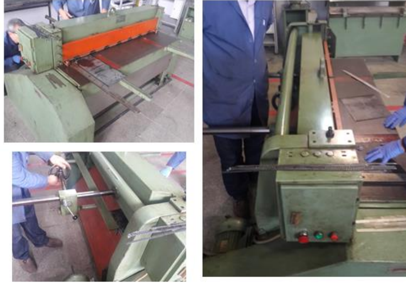
Şekil 3.7. Karbon fiber plakaların numune boyutlarında kesilmesi işlemi
