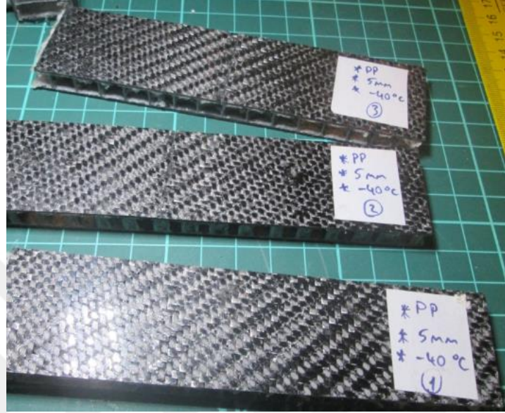
Şekil 4.26. -40°C'de 5 mm kalınlıkta PP çekirdekli sandviç numunelerinin üç nokta eğilme testi sonrası görünümleri
