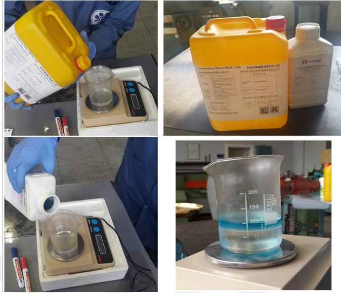
Şekil 3.5. Epoksi ve sertleştiricinin hesaplanan oranda ağırlıkça karışımı
