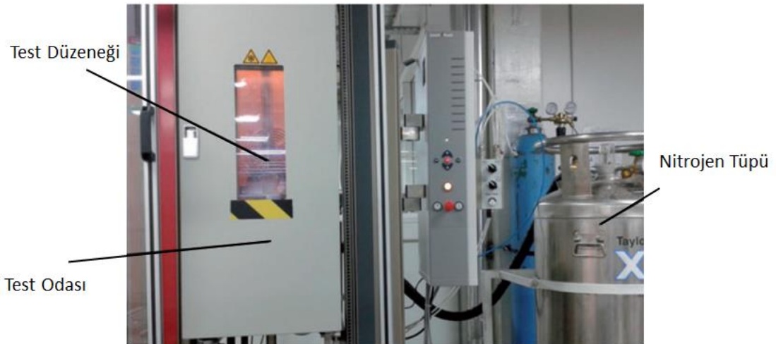
Şekil 3.18. Sıfırın altındaki sıcaklıklarda yapılan 3 nokta eğme test düzeneği ve şartlandırma odası
