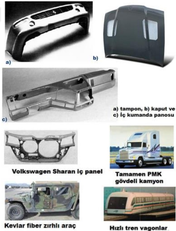
Şekil 2.30. Otomotiv ve ulaşımda kompozit kullanımına örnekler (Ertan 2016)
