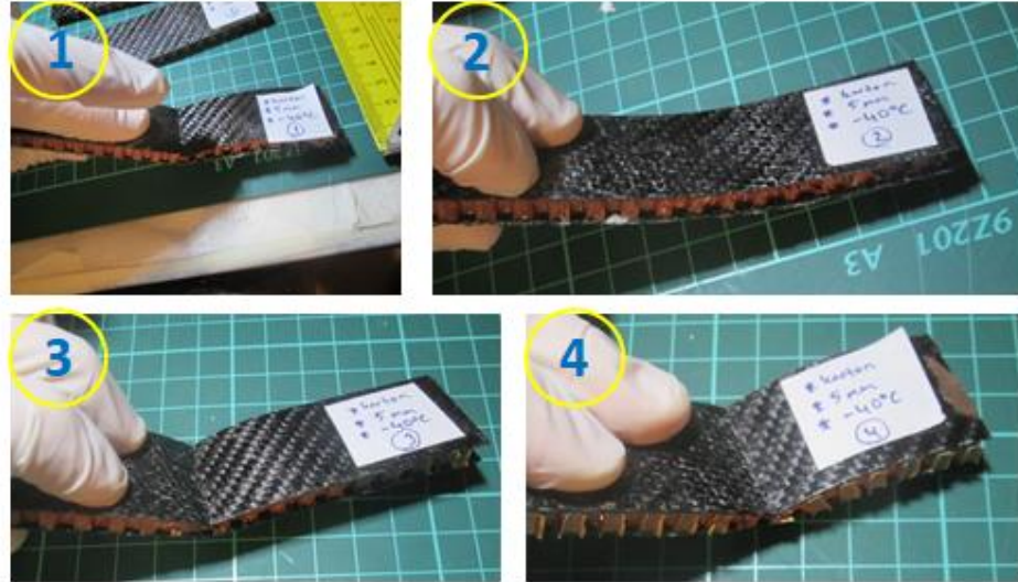
Şekil 4.21. -40°C’de 5 mm kalınlıkta Nomex çekirdekli sandviç numunelerinin üç nokta eğilme testi sonrası numune numarasına göre görünümleri
