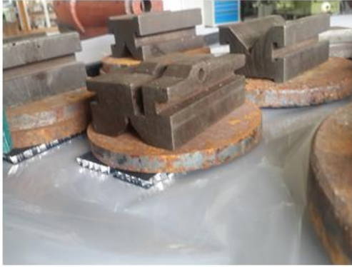
Şekil 3.15. Birleştirilensandviç numunelerinin ağırlık altında oda sıcaklığında kürlenme aşaması
