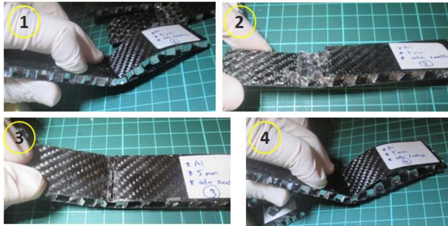
Şekil 4.15. Oda sıcaklığında 5 mm kalınlıkta Al çekirdekli sandviç numunelerinin üç nokta eğilme testi sonrası numune numarasına göre görünüşleri
