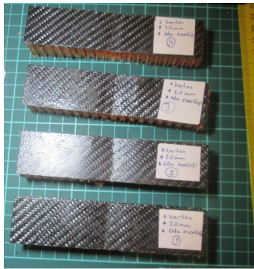
Şekil 4.5. Oda sıcaklığında 20 mm kalınlıkta Nomex çekirdekli sandviç numunelerinin üç nokta eğilme testi sonrası görünüşleri
