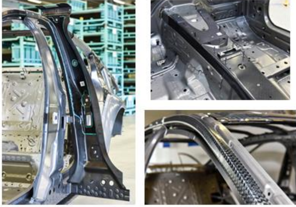
Şekil 2.27. BMW 7 gövdesinde kullanılan karbon fiber örnekleri (Gardiner 2016)
