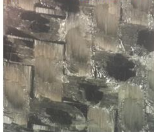
Gerilme yüzeyi Epoksi dağılımı
