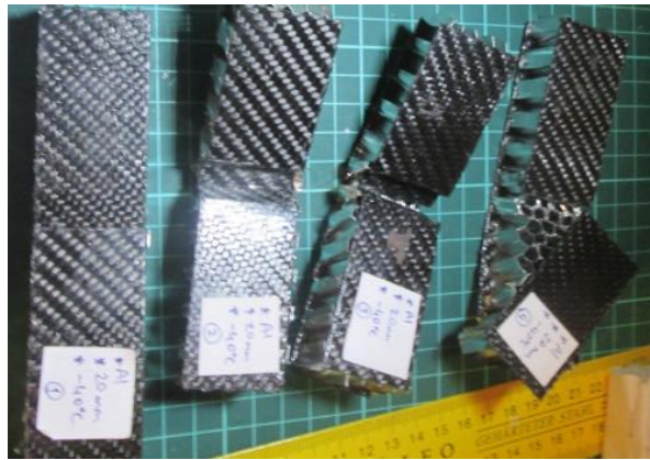
Şekil 4.35. -40^{\circ}\text{C} 'de 20 mm kalınlıkta Al çekirdekli sandviç numunelerinin üç nokta eğilme testi sonrası görünümleri
