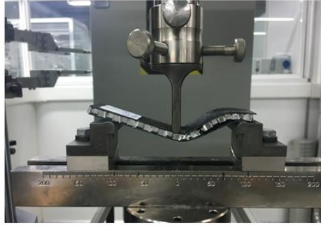
Şekil 3.20. 5mm kalınlıkta Al çekirdekli sandviç kompozit numunesinin 3 nokta eğilme testi
