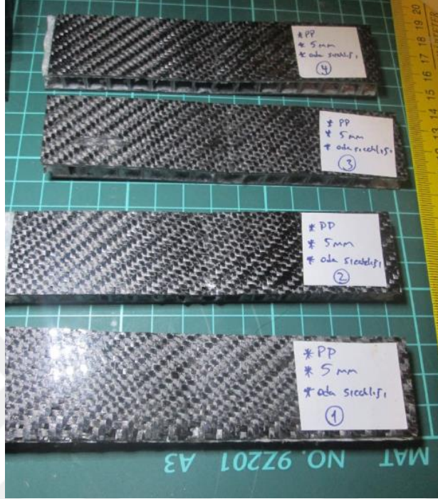
Şekil 4.8. Oda sıcaklığında 5 mm kalınlıkta PP çekirdekli sandviç numunelerinin üç nokta eğilme testi sonrası görünüşleri
