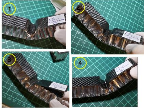
Şekil 4.18. Oda sıcaklığında 20 mm kalınlıkta Nomex çekirdekli sandviç numunelerinin üç nokta eğilme testi sonrası numune numarasına göre görünüşleri
