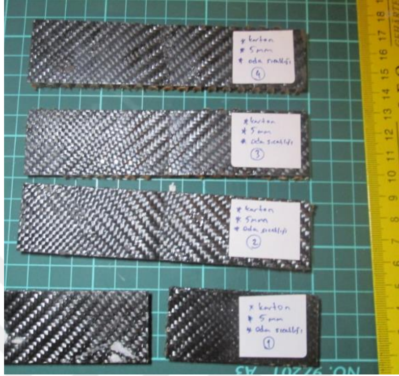
Şekil 4.2. Oda sıcaklığında 5 mm kalınlıkta Nomex çekirdekli sandviç numunelerinin üç nokta eğilme testi sonrası görünüşleri
