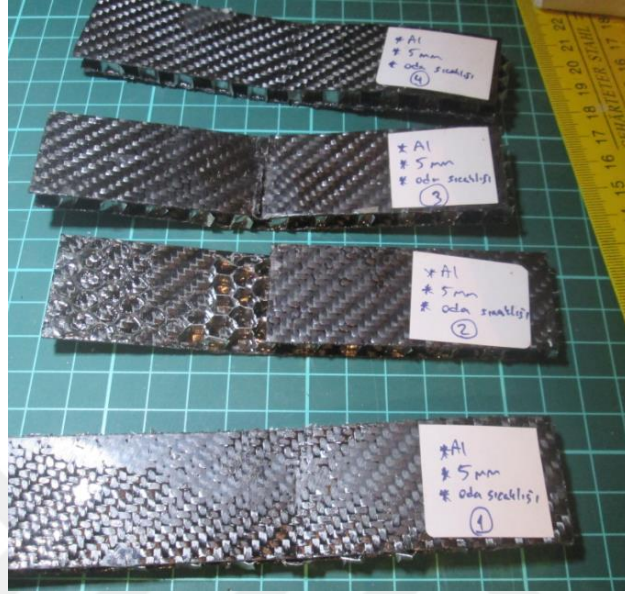
Şekil 4.14. Oda sıcaklığında 5 mm kalınlıkta Al çekirdekli sandviç numunelerinin üç nokta eğilme testi sonrası görünüşleri
