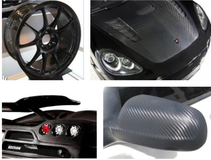
Şekil 2.31. Otomotiv alanında karbon elyaf kullanımına örnekler
