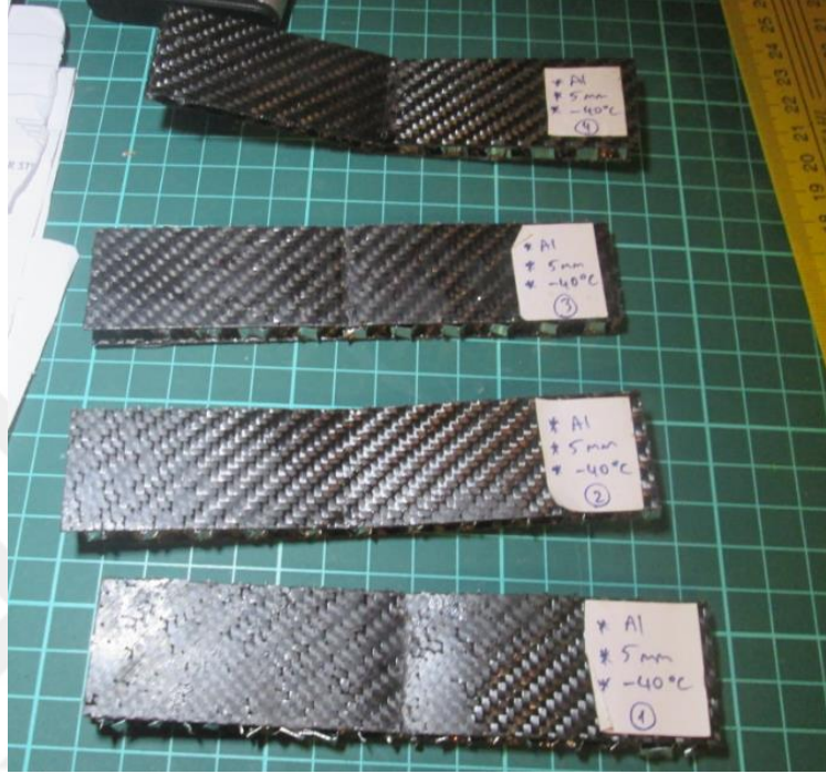
Şekil 4.32. -40°C'de 5 mm kalınlıkta Al çekirdekli sandviç numunelerinin üç nokta eğilme testi sonrası görünümleri
