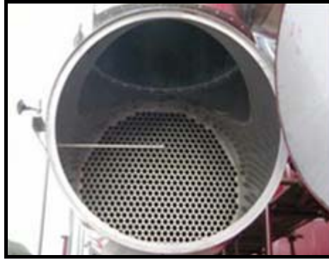
Şekil 2.24. Gövde-borulu ısı deęiřtirici enine kesiti (Karıřlı 2004)
