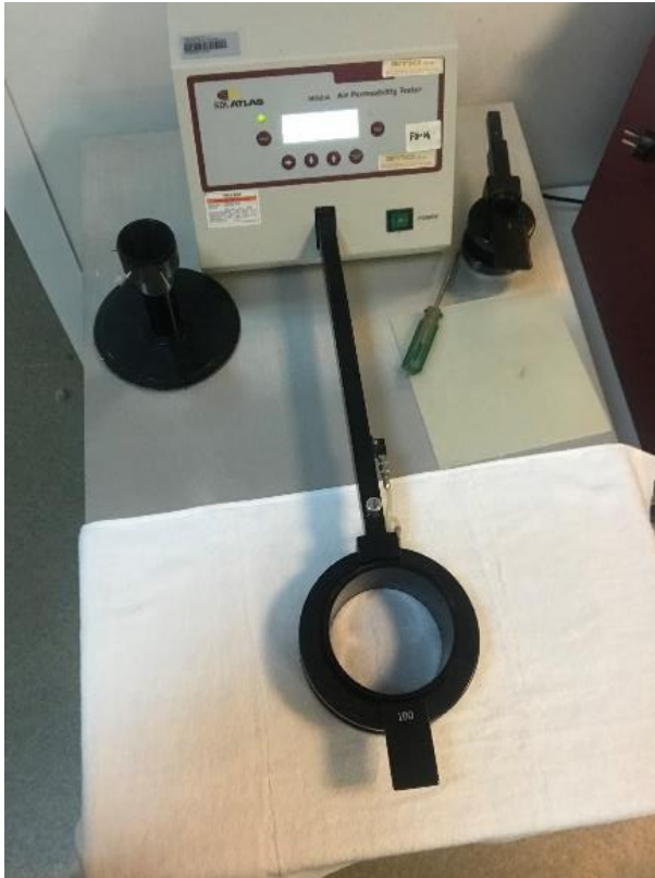
Şekil 3.4. Hava geçirgenliđi test cihazı (SDL Atlas M021A)
