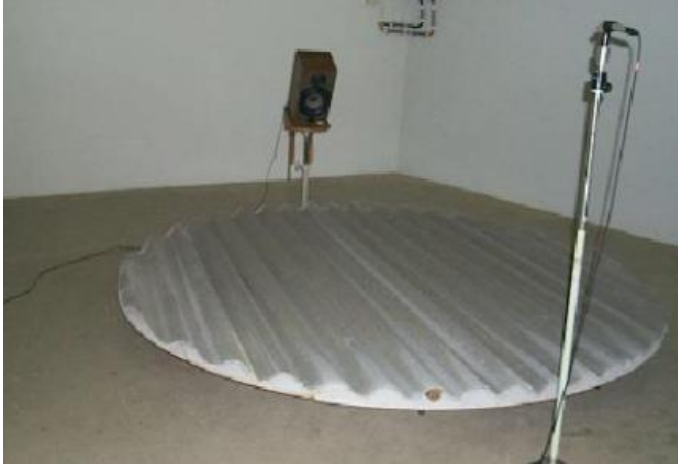
Şekil 2.14. Çınlanım odası gerçek ölçümü (Uzundağ ve ark.,2011)
