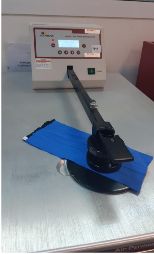
Şekil 3. 10. Hava geçirgenliği testi yapımı
