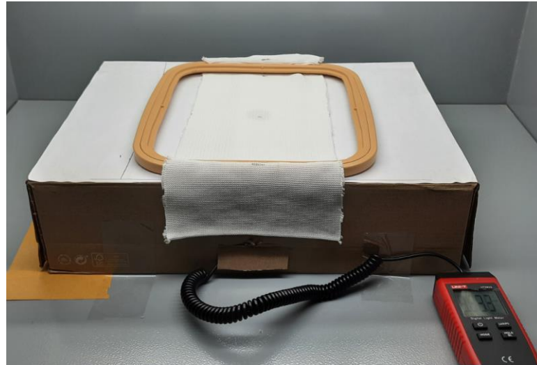
Şekil 3.14. Kumaş gerdirme tertibatıyla, belirli uzama değerlerindeki ışık geçirgenliği ölçümü
