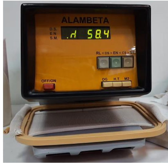
Şekil 3.12. Alambeta cihazında kumaş gerdirme tertibatıyla ısıl geçirgenliği ölçümü
