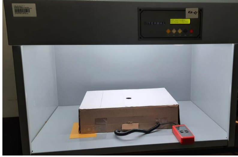
Şekil 3.13. Işık geçirgenliği ölçümü için oluşturulan deney düzeneği
