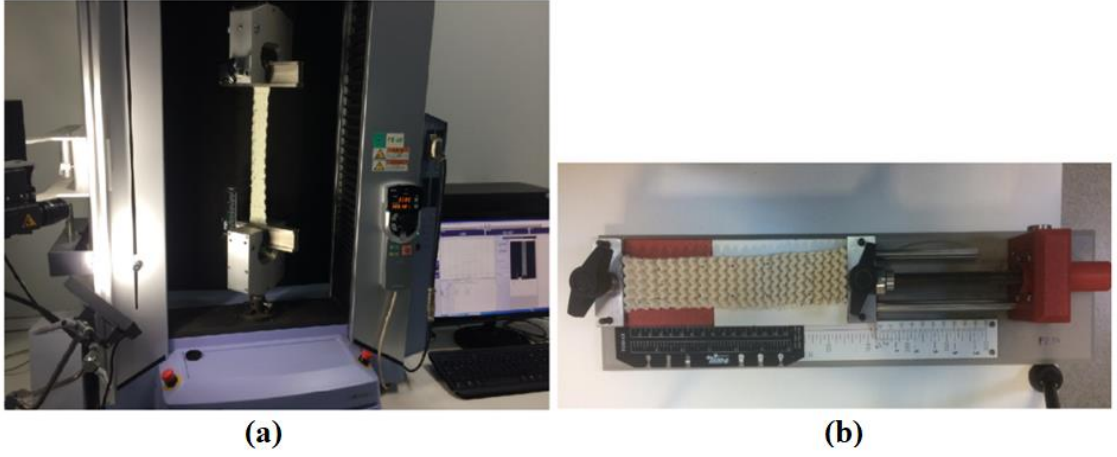
Şekil 3.4. Numunelerin a) UTT cihazına, b) Fryma ekstensometresine yerleştirilmesi
