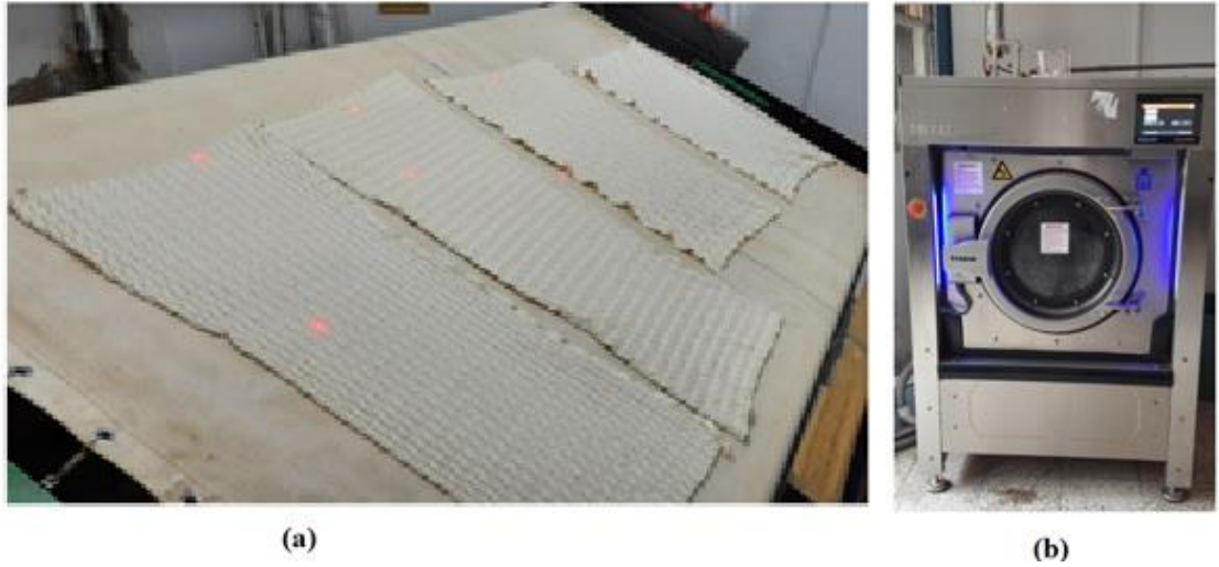
Şekil 3.3. Numunelerin a) buharlı paskarada relakse edilmesi, b) yıkama makinesi
