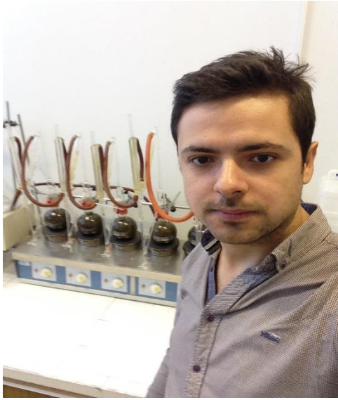
Şekil 3.31. Neo-Clevenger apereyi ile uçucu yağ eldesi
