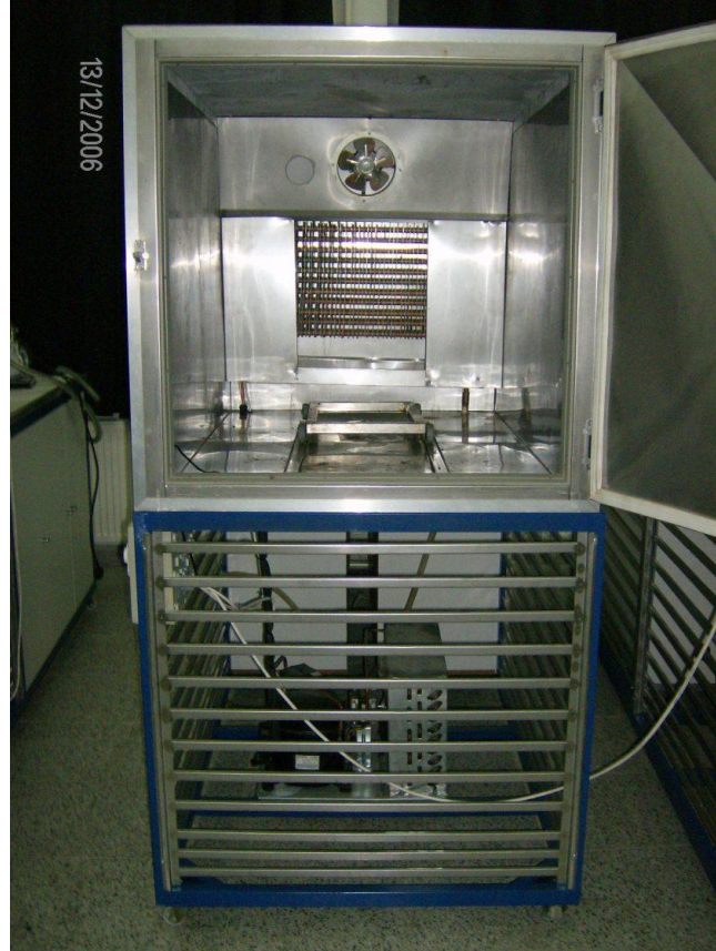
Şekil 2.10. Havayla ön soğutma sisteminin genel görünüşü
