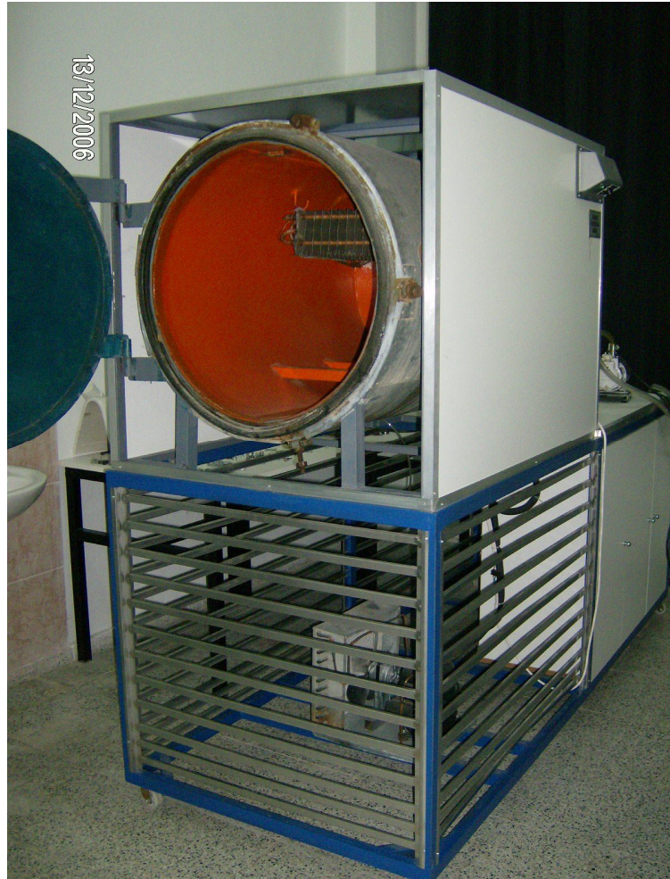
Şekil 2.14. Vakumla ön soğutma sisteminin genel görünüşü
