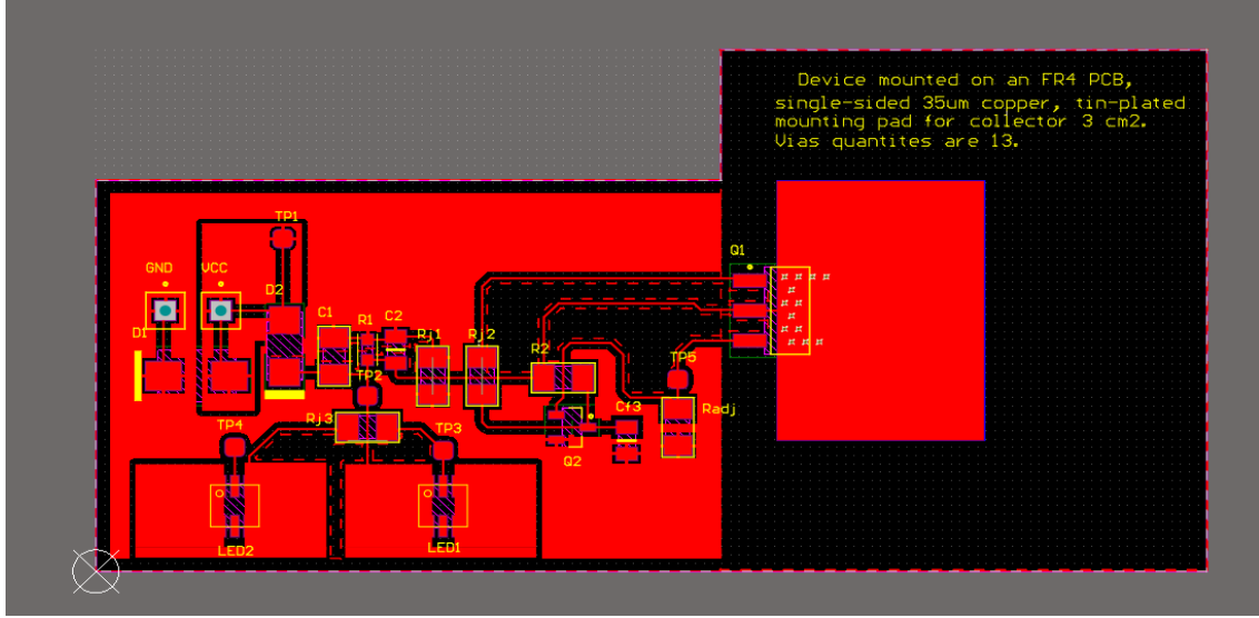
Şekil 4.36. 3 cm 2 alan genişliğine sahip 13 adet termo Via'lı PCB
