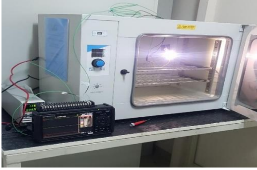
Şekil 4.26. PCB’nin fırın içerisindeki konumu
