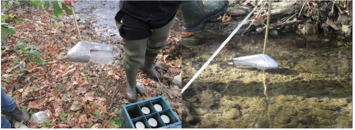
Şekil 3.26. Sediment numune alımı ve kullanılan deney ekipmanları
