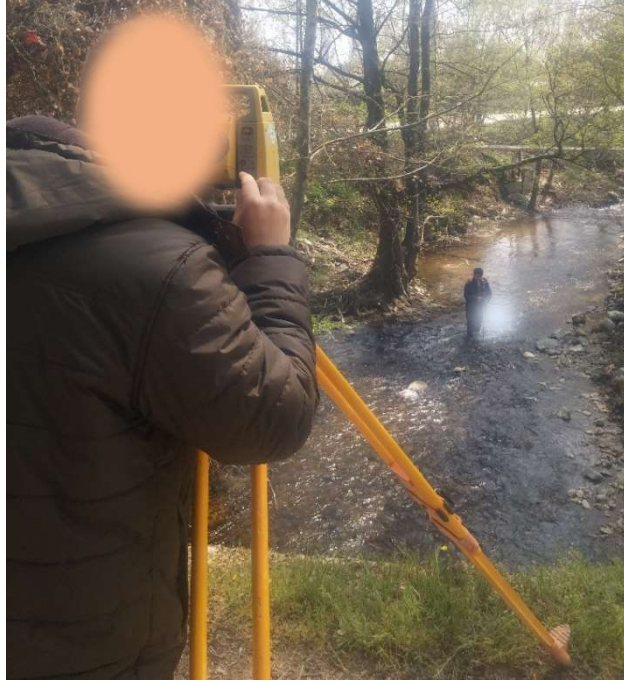
Şekil 3.14. Elektronik takometre ve reflektör cihazları ile koordinat alımı
