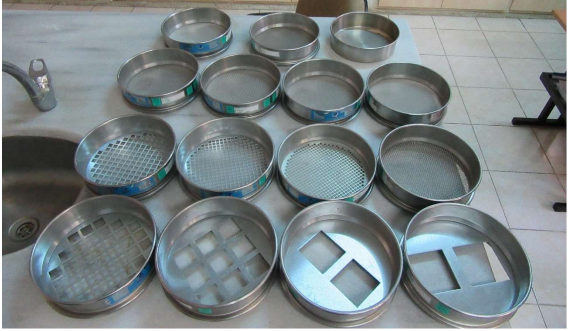
Şekil 3.21. TS EN ISO 17892-4 standardı elek takımı
