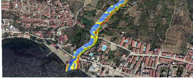
Şekil 4.32. Dere yatağında Nisan 2018 – Ekim 2019 dönemlerinde gerçekleştirilen topoğrafik okumalar arasındaki farkların alansal dağılımları
