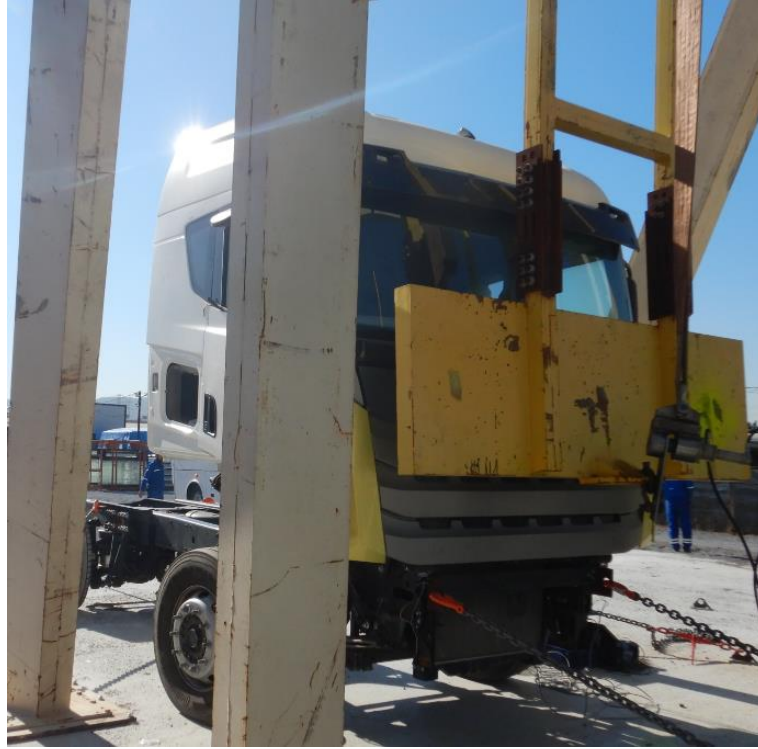
Şekil 3.38. ECE R29 Sarkaç Testi
