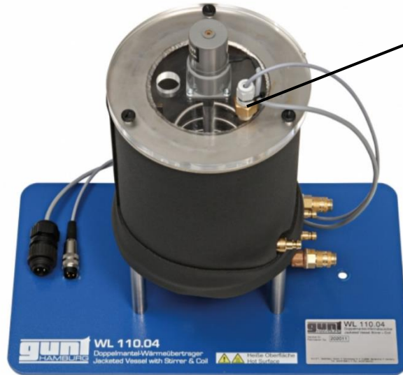
Şekil 3.15. Tank içerisindeki suyun sıcaklık verilerinin okunduğu sıcaklık sensörü
