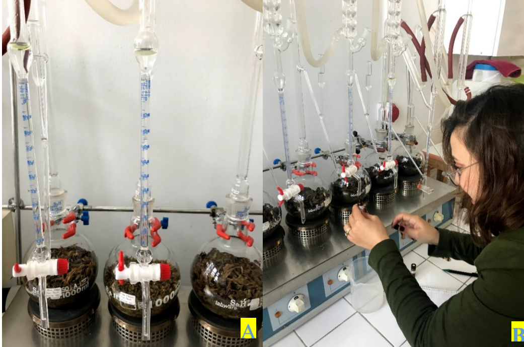
Şekil 3.15. Neo clevenger cihazında reyhan uçucu yağı eldesi A) Reyhan bitkisinin yaprakta ve çiçekte uçucu yağlarının eldesi B) Reyhan bitkisinin çiçekte elde edilen uçucu yağının alınması
