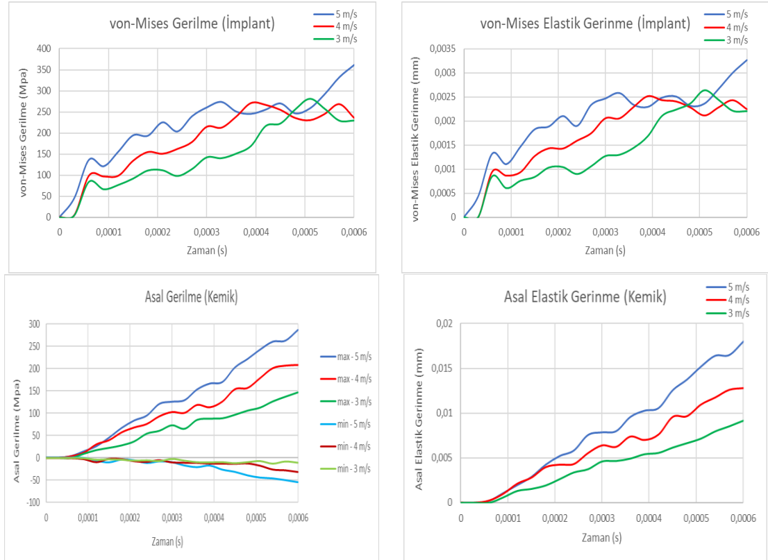
Şekil 4.80. Tasarım4-kemik sisteminin eksene dik kuvvet etkisi altında oluşan maksimum gerilme ve gerinme değerlerinin zamana bağlı değişim grafikleri
