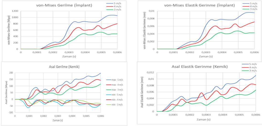
Şekil 4.71. Tasarım3-kemik sisteminin aksenal kuvvet etkisi altında oluşan maksimum gerilme ve gerilme değerlerinin zamana bağlı değişim grafikleri
