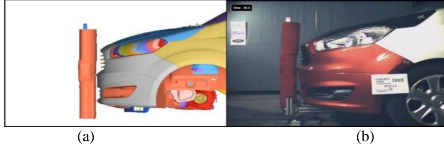
Şekil 4.2. Kemik-araç çarpışma a) Bilgisayar modeli, b) Fiziksel test benzetimi (Solak 2017)
