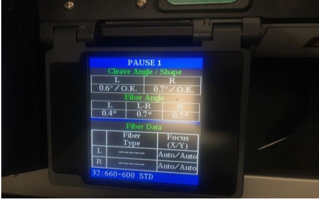
Şekil 3.20. Ek cihazında ek fiber ve QBH fiberi kesim açıları
