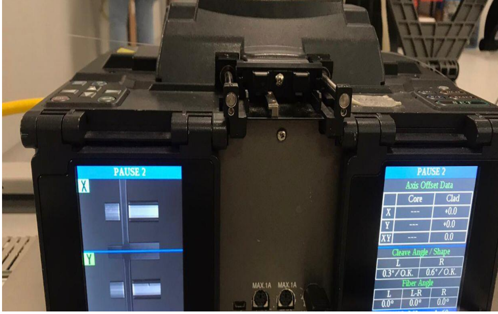
Şekil 3.14. Ek cihazında (splicer) diyot ve fiber birleştirici kesim açıları
