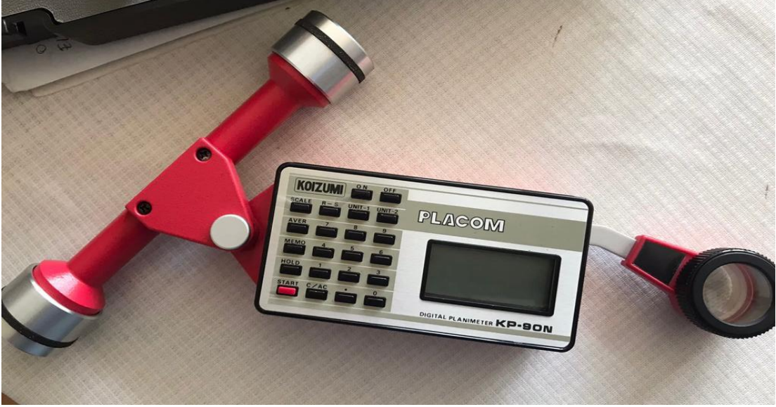
Şekil 3.2.2. Domates fidelerinin yaprak alanlarının ölçümünde kullanılan dijital planimetre (KOIZUMI KP-90N marka)
