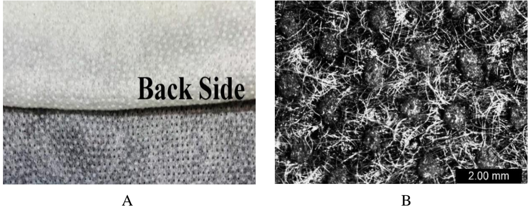
Şekil 2.3. A) Dokusuz yüzey tela, B) Dokusuz yüzey telanın mikroskop görünümü (Zhang ve Kan, 2018)
