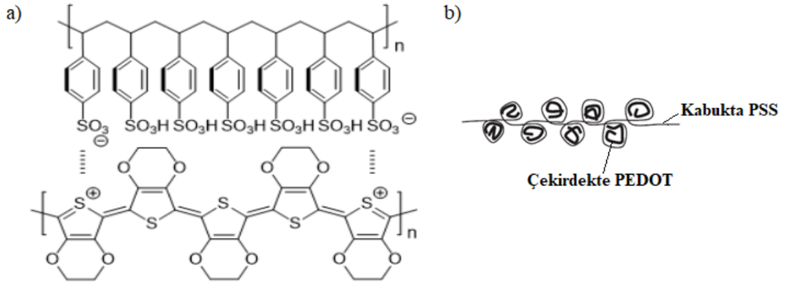
Şekil 2.19. a) PEDOT zincirlerinin PSS zincirleri ile etkileşiminin şematik gösterimi (Gueye ve diğerleri, 2020), b) PEDOT:PSS'nin çekirdek/kabuk yapısının şematik gösterimi (Xia ve Ouyang, 2011)
