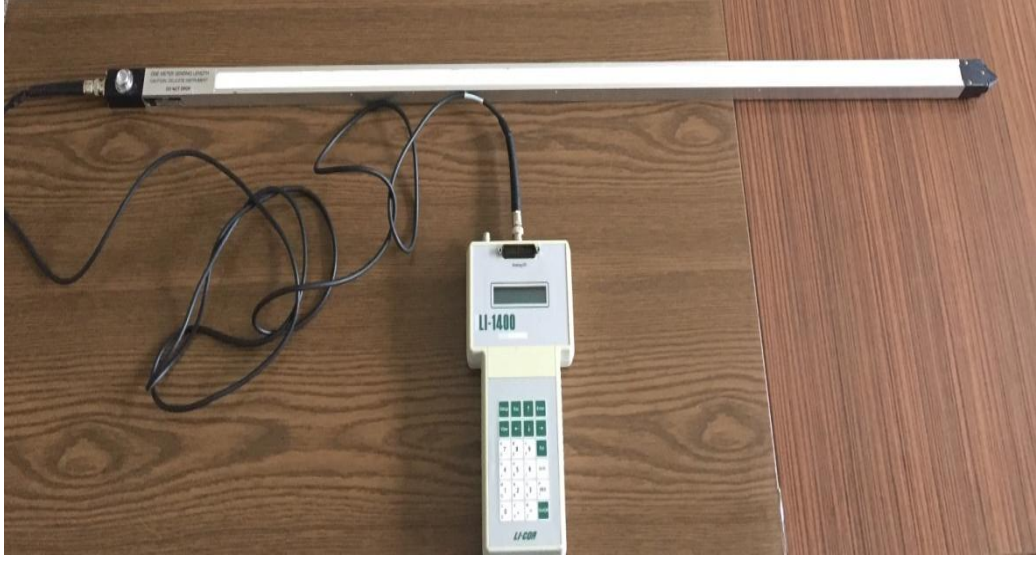
Şekil 3. 6. Işık ölçüm cihazı
