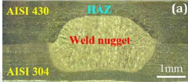
Şekil 2.6. Ostenitik paslanmaz iki farklı sac malzemenin makro görüntüsü- 2,5 kA (Bina ve ark. 2014)
