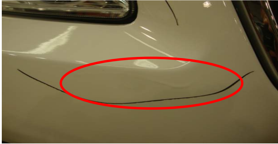
Şekil 4.44. Boya akması görsel örneği
