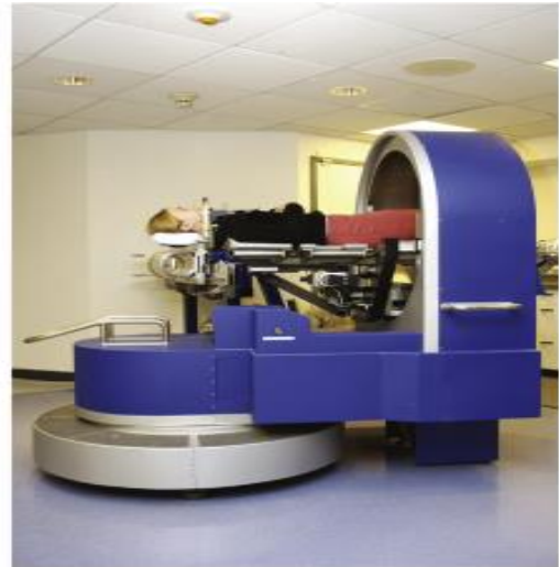
Şekil 8: Stereotaktik hizalama radyocerrahisi sistemi, Bir izosentrik hasta konumlandırma cihazı, hastayı sabit bir proton ışını hattı etrafında döndürmek için tasarlanmıştır ve beş serbestlik derecesine, üç doğrusal ve iki dönüşe sahiptir. Bu hareket eksenlerini kullanarak hasta, hedef lezyon ışın izomerkezinin merkezinde olacak şekilde konumlandırılır (Patel ve ark., 2016).
