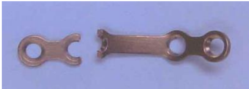
Şekil- 23. Statik çekme testi sonucunda kırılmış mini titanyum plak
